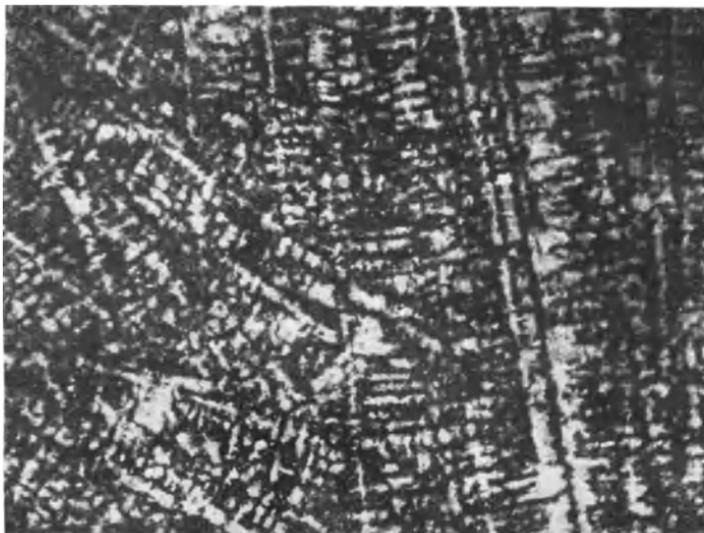
Abb. 37. Gleiches Gußstück wie nach Abb. 35, vier Stunden bei 1100°C gegläht. Das dendritische Gefüge ist noch stark ausgeprägt.  $\times 50$ .
