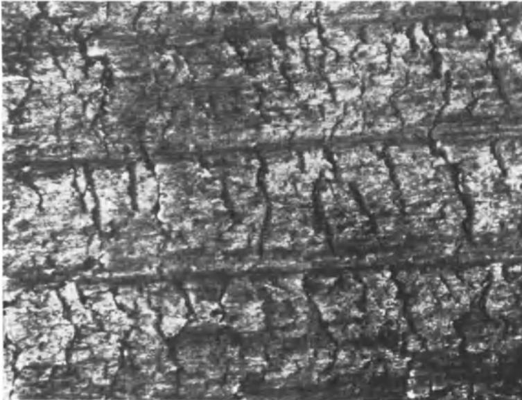
Abb. 77. Durch grobe Bearbeitung erhaltene rissige Oberfläche eines Stahlgegenstandes.
