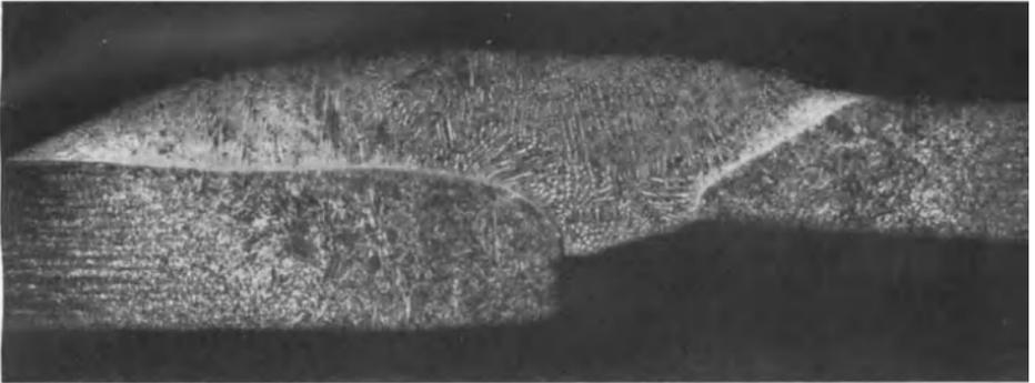
Abb. 44. Überlappungsschweißung von zwei Blechen aus rostfreiem Eisen nach Verwendung eines besonderen Schweißstoffes.  $\times 18$ .
