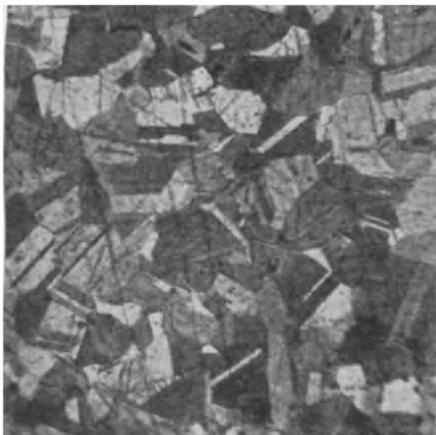
Abb. 97. Ankastahl mit 0,10 vH Kohlenstoff, 15,2 vH Chrom und 11,4 vH Nickel, vollständig weich gemacht.  $\times 300$ .
