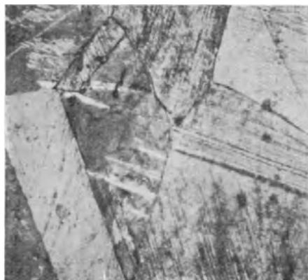
Abb. 30. Stahl mit 0,67 vH Kohlenstoff und 14,1 vH Chrom von 1200° C abgeschreckt. Austenit.  $\times 500$ .
