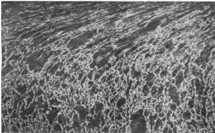
Abb. 78. An der Oberfläche verzerrtes Gefüge eines Stahlgegenstandes.  $\times 100$ .
