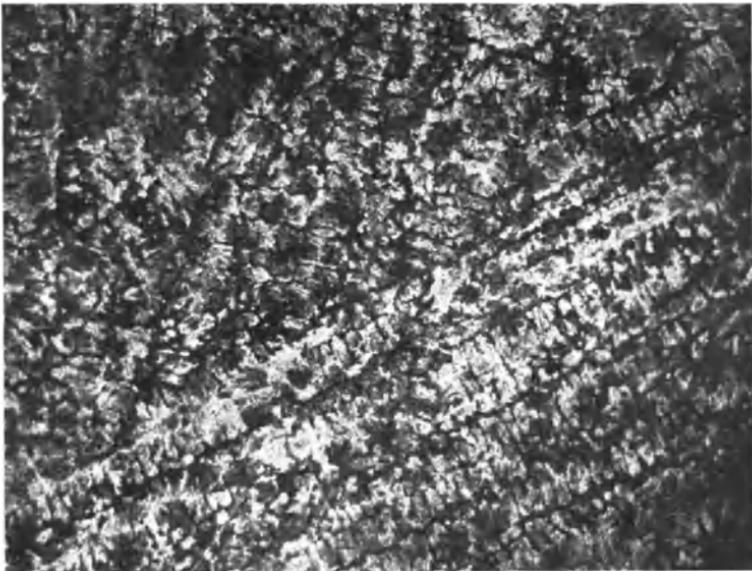
Abb. 35. Dendritisches Gefüge eines Gußstückes aus rostfreiem Stahl mit 0,42 vH Kohlenstoff und 11,3 vH Chrom nach langsamer Abkühlung nach dem Guß.  $\times 50$ .
