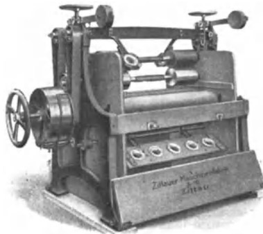
Abb. 18. Chlor- und Säuremaschine mit drei Hartholzwalzen und zwei Quetschwalzenpaaren. (Zittauer Maschinenfabrik A.-G., Zittau i. Sa.)
