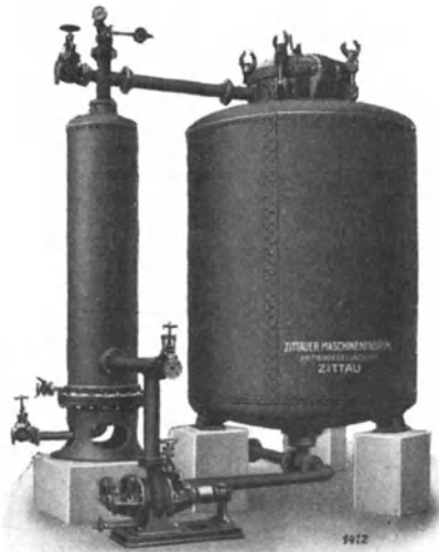
Abb. 17. Hochdruckkessel mit Vorwärmer, Zirkulations-Zentrifugalpumpe, Doppelboden und Standrohr. (Zittauer Maschinenfabrik A.-G., Zittau i. Sa.)
