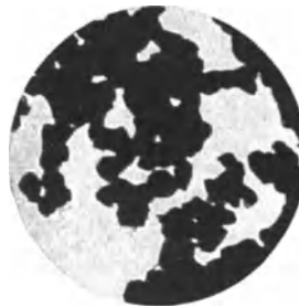
Elektronenmikroskopisches Bild. Es zeigt trotz sechsmal so hoher Vergrößerung die genaue Form sehr kleiner Teilchen. Vergr.: 13000fach.
