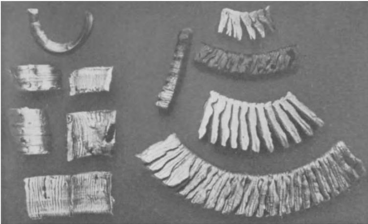
Abb. 105<sup>1)</sup>. Späne mit deutlicher Bildung von Spánelementen.
