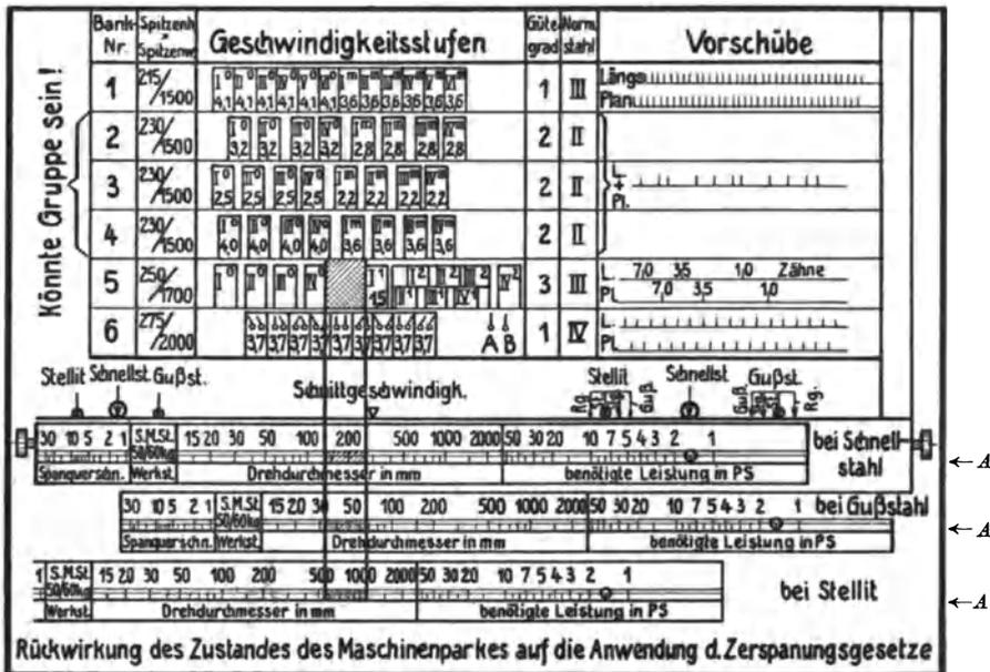
Abb. 151<sup>2)</sup>. Neue Bankbestimmungstafel bei Prüfung des Zustandes des Maschinenparkes,
