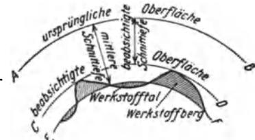
Abb. 108. Unregelmäßige Oberfläche bei Abreißspänen.
