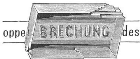
Abb. 534. Doppelbrechung im Kalkspat.
