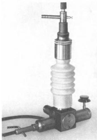
Abb. 217. Offene Glühkathodenröhre für spektroskopische Zwecke nach SIEGBAHN.
