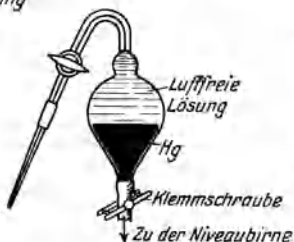
Abb. 31. Reservoir, aus dem ein \text{CaCl}_2 -Rohr hergestellt.
