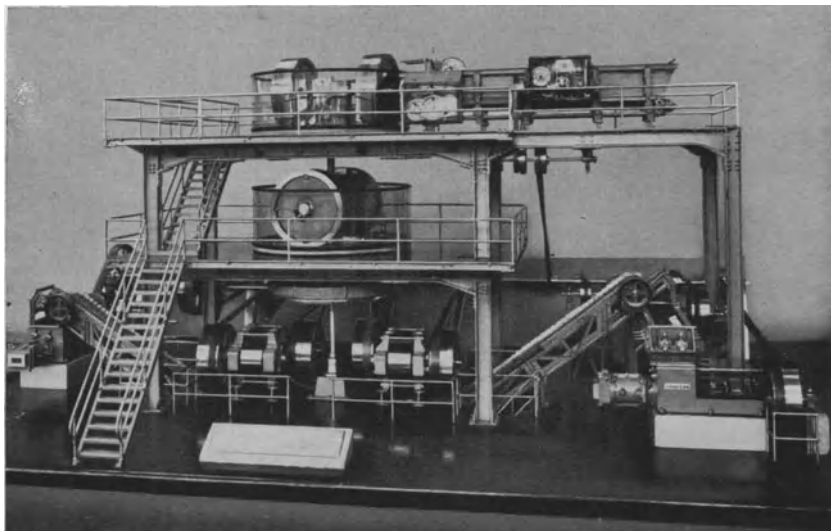
Abb. 51. Anlage zur Herstellung von Rohsteinen für Ziegel: Durch den Kastenbeschicker werden die richtig zusammengestellten Stoffe (Ton und Sand) dem Kollergang zugeführt, der sie knetet und durchmischt. Darauf passieren sie dann Walzwerke und werden den Ziegelpressen zugeführt wo sie ihre Form erhalten. Leistung 250 cbm in 8 Stunden bei 200 PS Bedarf (Modell: Händler & Söhne, Mühlacker).
