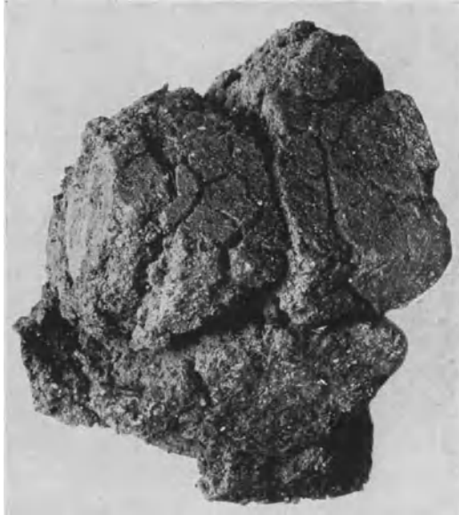
Abb. 41. Bild einer Fettzerstörung. Fette, beispielsweise Leinöl, werden durch den Kalk des Mörtels verseift. Durch Verwandlung des Kalkanteils des Zementes in Kalkseife wird der Zusammenhalt des Mörtels gelöst, gleichzeitig treten Treiberscheinungen auf.
