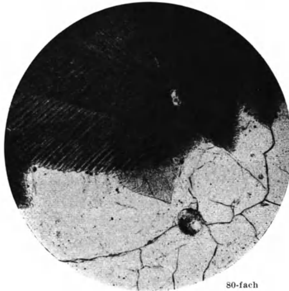
Abb. 25. Dünnschliff von Hochofenschlacke: Hochofenschlacke muß in glasiger Form dem Zement zugemahlen werden, da sie sonst kein Erhärtungsvermögen hat. Entglaste, also kristallisierte Hochofenschlacke dient nur als Betonzuschlag. Eisenportlandzement enthält bis zu 30% Schlacke, Hochofenzement bis zu 85% Schlacke. Auf dem Bild ist eine durch partielle schnelle Abkühlung teilweise glasig gewordene (unterer Teil), teilweise kristallisierte (oberer Teil, Melilith-Bildung) Hochofenschlacke dargestellt.
