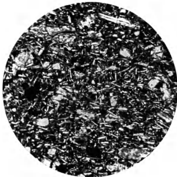
Abb. 28. Tonerdezement: Das Bindemittel unterscheidet sich wesentlich vom Portlandzement (Abb. 24). Tonerdezement besteht aus Calciumaluminiumsilikat, dessen Formel völlig anders ist als diejenige des Tricalciumsilikates aus dem Portlandzement.
