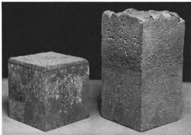
Abb. 49. Porenbeton. Das Bild zeigt die gleiche Zementmenge einmal als Purzement angemacht wie Mörtel (links), das andere Mal aufgebläht durch Gase (rechts): Die größere Leichtigkeit des Porenbetons erhöht auch seine Wärmehaltung infolge Gasgehalts.
