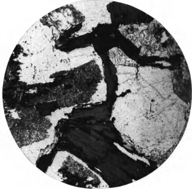
Abb. 6. Dünnschliff von Tiefengestein (Granit): Die einzelnen, den Granit aufbauenden Mineralien, wie Feldspat, Glimmer, sind deutlich zu sehen. Sie sind bei der langsamen Erstarrung, gut auskristallisiert und fest verkittet.
