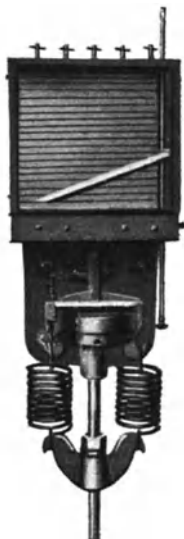
Abb. 116. Hauptregler von Smoot steuert Hilfsluftdruck.
