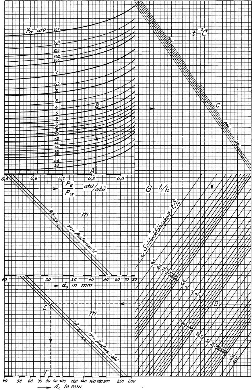
Abb. 30. Kurvenschar zur Bestimmung des Drosselquerschnittes von Flanschen und Ventilen. p_a = Anfangsdruck, p_e = Enddruck, t = Anfangstemperatur, d_o = Durchmesser bei kreisförmigem Querschnitt.
