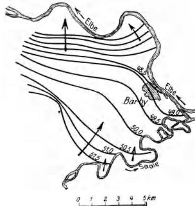
Abb. 304. Unterirdischer Ausgleich von Flußgefälle unter Grundwasserbildung.
