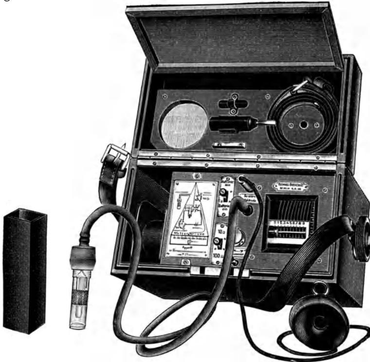
Abb. 177. Tragbarer Apparat zur Messung des Leitvermögens von Wässern. (Nach Pleißner.)
