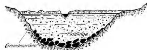
Abb. 21. Schnitt durch einen Grundwasserträger mit einer Pflasterersohle.
