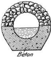
Abb. 258. Sickerstrang aus Beton und Trockenmauerwerk.
