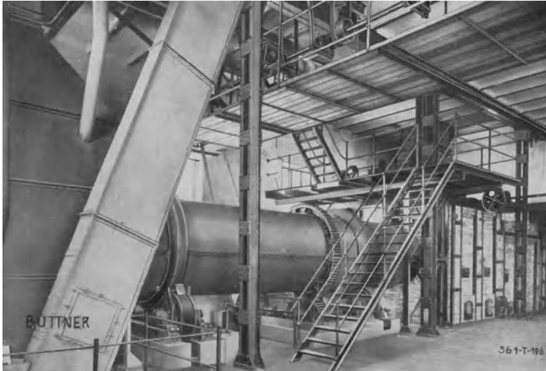
Abb. 5. Büttner-Trocknungsanlage für Rübenblätter.
