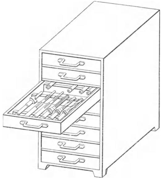
Abb. 104. Schrank mit Werkzeugordnungskästen.
