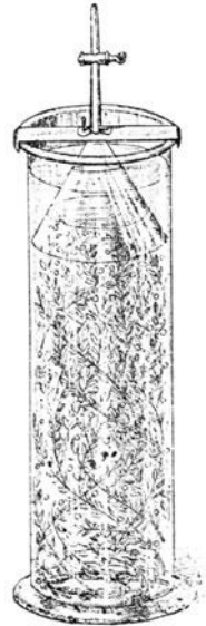
Fig. 172. Apparat (nach Pfeffer) zum Nachweis der Sauerstoffausscheidung bei der Assimilation.
