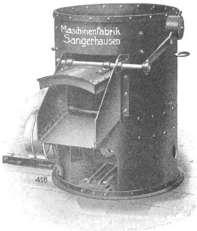
Fig. 15. Schälmaschine.
