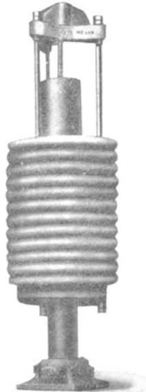
Fig. 32. Druckwasserakkumulator.
