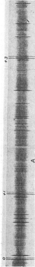
Abb. 5. 1.—3. Ordnung im Resonanzspektrum des Joddampfes bei Erregung mit der Linie 5461; darunter das kannelierte Bandenspektrum.
