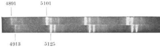
Abb. 27. a) Fluoreszenzspektrum des Uranylatriumsulfats } bei -193°.
