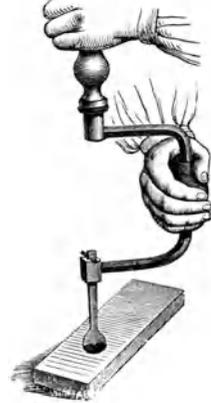
Löcher die „Windbohrer“ (Fig. 57), welche in die „Brustleier“ oder „Bohrwinde“ (Fig. 58) eingesetzt werden. In diese kommen auch die „Zentrumsbohrer“ (Fig. 59) zum Bohren sehr großer Öffnungen. Sehr nützlich sind auch die „Löffelbohrer“ (Fig. 60 u. 61), die zylindrisch und konisch vorkommen.
