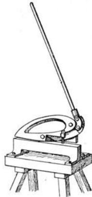
Für noch stärkere Bleche verwendet man die „Hebelblechscheren“ (Fig. 138). Die große Hebelstange wird abwärts bewegt, dadurch gleitet die Schneide des beweglichen Messers an der des feststehenden entlang und schneidet das dazwischen gelegte Blech ab. Eine eiserne Schraube dient dazu, das untergeklemmte Material beim Schneiden festzuhalten. Diese Scheren schraubt man entweder fest auf der Werkbank an oder auf einem starken niederen Tisch, der eigens zu diesem Zweck angefertigt ist.
