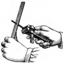
in der der Gewindebohrer durch ein Zweibackenfutter festgehalten wird, welches durch eine übergeschraubte, konische Mutter
