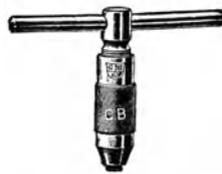
festgezogen wird. Das „verstellbare Windeisen“ (Fig. 227) enthält, ähnlich den Kluppen, zwei Backen, die durch eine mit einem Griff versehene Schraube angezogen wird.
