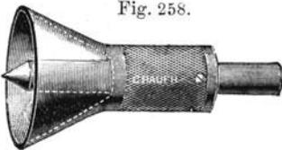
2. Der „Zentriertopf“, der aus einem größeren konischen Teil besteht, in dem ein zylindrischer Stab, der eine gehärtete Kernerspitze trägt, verschoben werden kann (Fig. 258).
