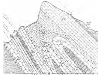
Abb. 114. Erosierte überkippte Mulde im Gebirgsverband, geteilt durch zwei überkippte isoklinale Spezialsättel (*tg, td* Trias, *lc, ls* Lias). Croise des Têtes (französ. Alpen) (nach Kilian und J. Revil aus O. Wilkens Grundzüge der tekt. Geologie)
