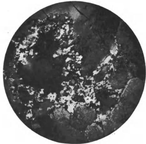
Abb. 14. Kataklastischer Granit (Zermörtelung des Quarzes). Schöllenen, Uri (nach Grubenmann-Niggli)
