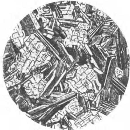
Abb. 20. Bronzidiabas. York, Pa., U. S. A. Ophitische Struktur (Dünnschliffbild) (nach Rosenbusch)
