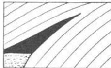
Abb. 68. Auskellendes Schenkellager. Unten Wasser, oben Öl in der von undurchlässigen Schichten eingeschlossenen Sandlage
