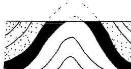
Abb. 182. Durch Erosion entfernter Faltenscheitel
