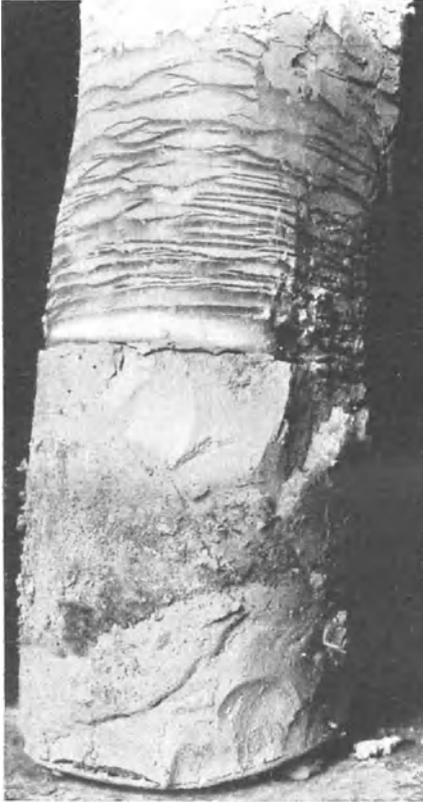
Abb. 327. Erweiterung vorhandener Fugen durch den Kristallisationsdruck frierenden Wassers (nach S. Taber)
