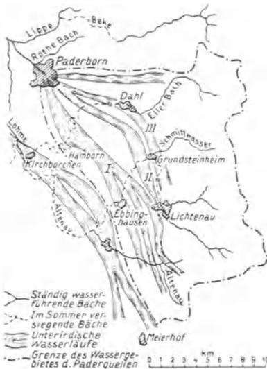
Abb. 351. Unterirdische Wasserläufe bei Paderborn (nach Stille)
