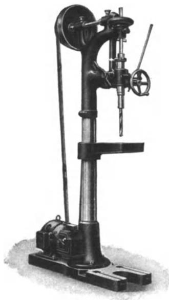
Abb. 59. Säulenbohrmaschine, Motor am Fuß.
