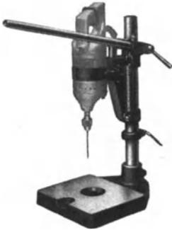
Abb. 55. Kleinhandbohrmaschine im Tischbohrständer.
