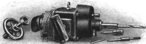
Abb. 17. Handbohrmaschine mit Rädervorgelege aus dem Jahre 1901 (auch Drehstrom).
