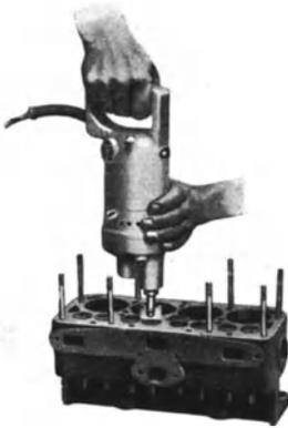
Abb. 50. Einschleifen von Ventiltellern.
