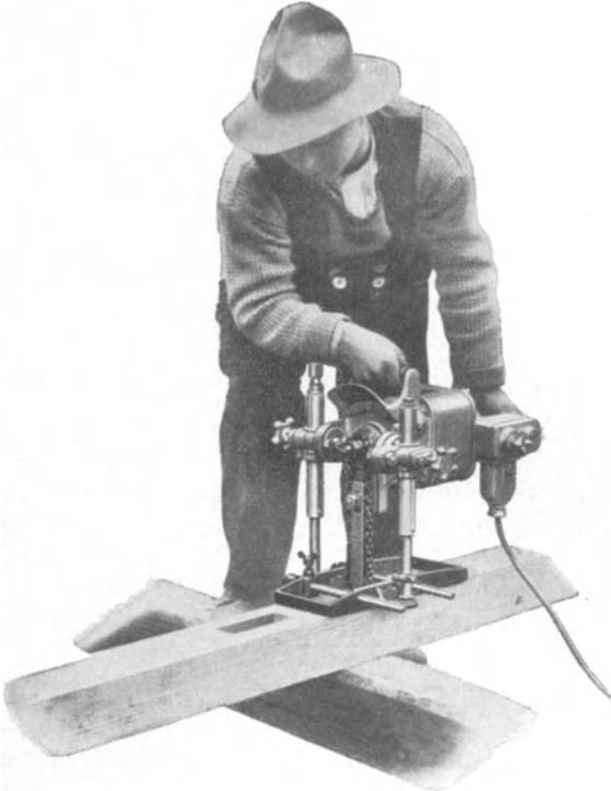
Abb. 89. Fräsen von Dollenlöchern mit der Kettenfräse.
