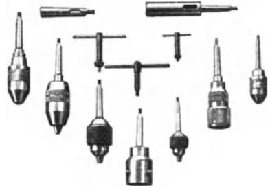
Abb. 23. Verschiedene gebräuchliche Bohrfutter und Übergangskegel.
