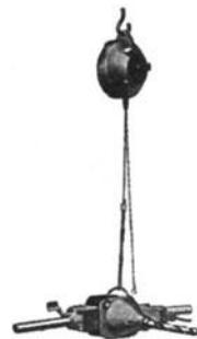
Abb. 15. Handbohrmaschine am Federzug.
