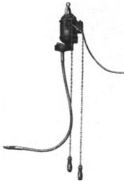
Abb. 108. Hängemotor mit Rädervorgelege und biegsamer Welle, Zugschalter.
