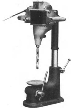
Abb. 57. Handbohrmaschine auf Bohrtisch, Bohrtisch beweglich.
