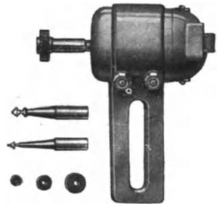
Abb. 68. Spitzenschleifer mit Spannschiene und Verlängerungsspindeln.
