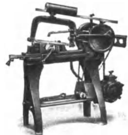
Abb. 85. Leicht umstellbare Bügelschnellsäge.
