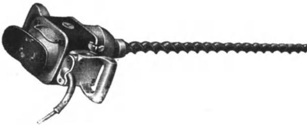
Abb. 38. Gesteinsdrehbohrmaschine mit Bohrer.
