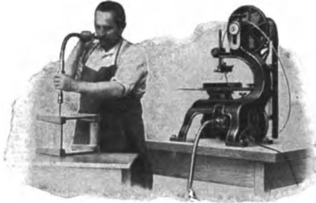
Abb. 107. Tischbandsäge mit angeschlossener biegsamer Welle bei Bohrarbeiten.
