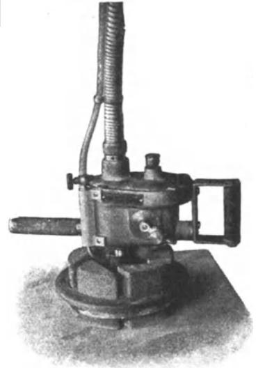
Abb. 125. Schleifen von Flächen mit Winkelgetriebe, Segmentscheiben und Wasserkühlung.
