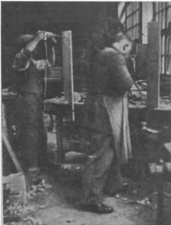
Abb. 35. Vergleich zwischen Kleinhandbohrmaschine und Bohrwinde.
