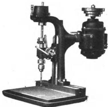
Abb. 58. Schnellbohrmaschine für Leichtmetall, 10000 Umdr./Min., Motor am Kopf.
