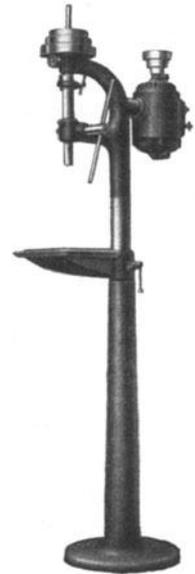
Abb. 62. Säulenschnellbohrmaschine, Motor am Kopf.
