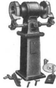
Abb. 74. Werkzeug-Schleifbock.
