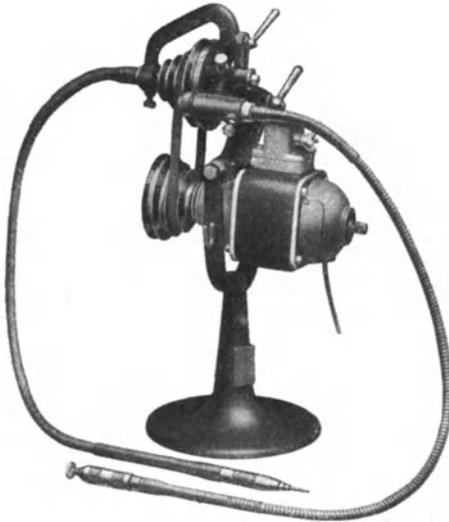
Abb. 109. Vielfachantriebsmaschine mit Kraftwelle und Schnelltrieb.
