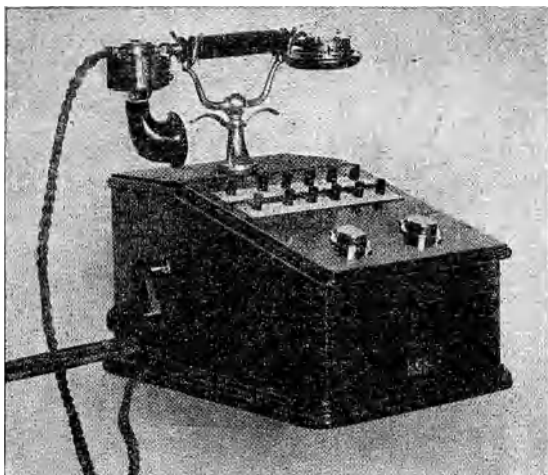
Abb. 443. Tischgehäuse für 2 Amtsleitungen und 10 Nebenstellen; Gehäuse für eine Nebenstelle.
