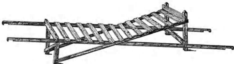
Abb. 182. Nottrage, aus Dachlatten mit doppelt geneigter schiefer Ebene.
