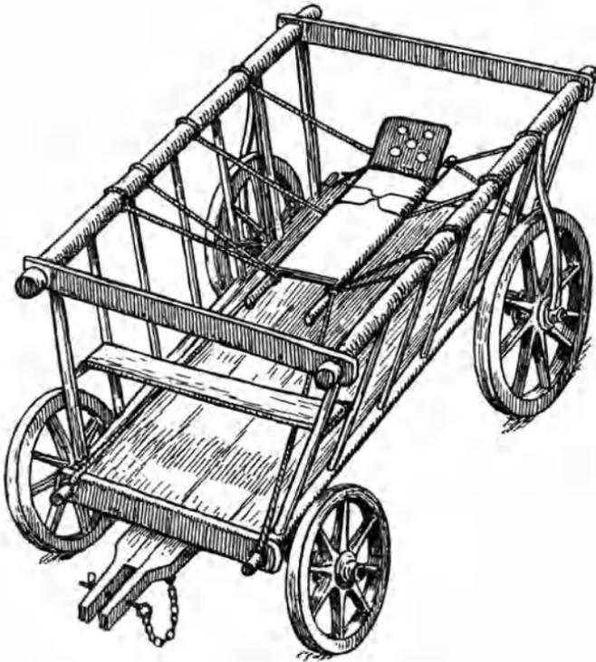
Abb. 210. Befestigung einer Trage auf einem Leiterwagen.
