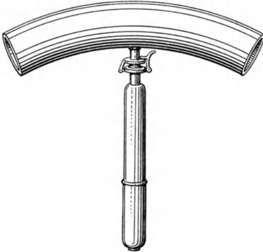
Abb. 249. Verwendung einer Radfahrer-Luftpumpe zum Aufblasen von Luftkissen mittels besonderen Ansatzes.
