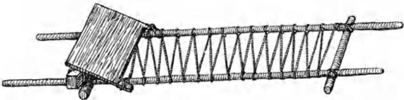
Abb. 180. Nottrage, aus Baumstämmchen, Stricken und einem Brett hergestellt. Die Spannholzer sind an der Unterseite der Tragestangen angebracht und dienen so zugleich als Tragefüße. Die Kopflehne, aus einem Brettstück gefertigt, erhält ihre schiefe Lage durch ein untergeschobenes Stück Kantholz.
