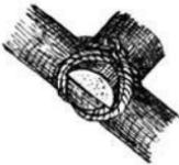
Abb. 179. Nottrage, aus Längsstangen, Querhölzern und Stricken gefertigt. Die Füße sind dadurch befestigt, daß die Rundhölzer am oberen Ende eingekerbt und an die etwas abgeflachten Tragestangen gebunden werden (siehe Nebenabbildung).
