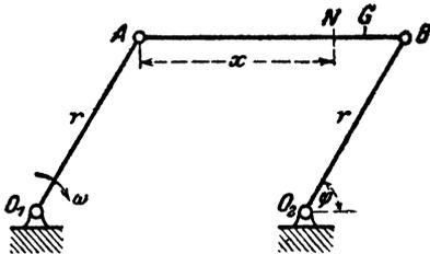
ist  $AB = O_1 O_2$ . Man ermittle für irgendeine Stelle  $N$  der Stange in der Entfernung  $x$  von  $A$  das Biegemoment  $M$ , die achsiale Kraft  $N$  und die Querkraft  $Q$ , soweit sie von den Trägheitskräften herrühren. Wo sind diese drei Größen am größten und kleinsten?
