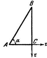
3. Ein kleines rechtwinkliges Prisma von den Kanten a, b, c wird am Ende mit der Kraft P belastet. Welche Schubspannung  $\tau$  tritt in der strichlierten Diagonalebene auf?
