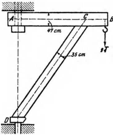
folgende Abmessungen:  $AC = 3$  m,  $CB = 1$  m,  $AD = 4$  m. Die größte Last in B beträgt 9 t. Der Querschnitt des Balkens AB ist ein Rechteck (35 cm und 47 cm), jener der Strebe DC ein Quadrat (35 cm). In A und D ist der Kran mit schweißeisernen Bolzen drehbar befestigt. a) Wie groß ist die größte in AB auftretende Spannung? b) Wie groß ist die auf DC entfallende Druckkraft und wie groß ist die Tragfähigkeit der Strebe DC, wenn  $k = 80$  at die zulässige Druck-
