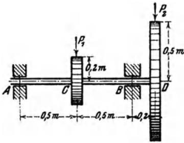
und 0,5 m). Die Belastungen der Welle sind  $P_1 = 350$  kg,  $P_2 = 200$  kg. Das eine Rad überträgt auf das andere  $N = 8$  PS, die Welle macht  $n = 80$  Umdrehungen in der Minute. Die zulässigen Spannungen sind:  $k_z = 200$  at für Zug,  $k_d = 200$  at für Drehung. Berechne den Wellendurchmesser  $d$ .
