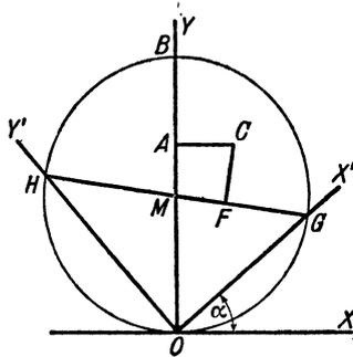
159. Die Punkte  $OABC$  haben die gleiche Bedeutung wie in der vorhergehenden Aufgabe.  $X'Y'$  sei ein um  $\alpha$  gedrehtes rechtwinkliges Achsenkreuz. Man zeige, daß die diesem Achsenkreuz entsprechenden Flächenmomente zweiter Ordnung durch folgende Strecken gegeben sind:
