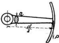
189. Eine gußeiserne Riemenscheibe vom Durchmesser  $d = 0,4$  m macht  $n = 60$  Umdrehungen in der Minute und überträgt  $N = 12$  PS. Sie besitzt  $4$  Arme von elliptischem Querschnitt; das Achsenverhältnis der Ellipse soll  $a : b = 2 : 1$  sein. Die zulässige Zugspannung ist  $k_z = 150$  at. Man soll die Abmessungen  $a$  und  $b$  des Quer-
