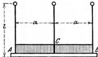
\*514. Ein gleichförmig belasteter Träger ist an dem einen Ende eingespannt, an dem anderen frei auflagernd. Man soll die Auflagerdrücke in A und B sowie das Einspannungsmoment finden.
