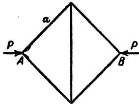
98. Ein quadratisches Stabwerk wird durch zwei gleiche Kräfte  $P$  zusammengedrückt. Die fünf Stäbe haben denselben Querschnitt  $F$  und sind aus dem gleichen Material. Um wieviel nähern sich die Punkte A und B?
