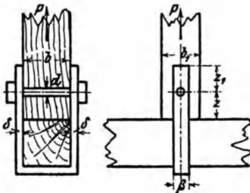
Bandes von der Stärke  $\delta = 15$  mm mit einem Balken verbunden werden. Die zulässigen Spannungen sind für Eisen:  $k_z' = 750$  at Zug,  $k_s' = 600$  at Schub; für Holz:  $k_z'' = 100$  at Zug,  $k_s'' = 10$  at Schub. Es sollen gerechnet werden: a) der Durchmesser  $d$  des Schraubenbolzens; b) die Breite  $b_1$  der
