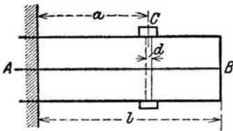
**\*368.** Ein rechteckiger Balken von der Höhe  $h$  und dem Gewicht  $G$  ist in der Mitte A B durchschnitten; die beiden Hälften werden in C durch eine Schraube zusammengehalten. Welchen Durchmesser  $d$  muß die Schraubenspindel erhalten, wenn die zulässige Zugspannung  $k_z$  des Eisens gegeben ist?
