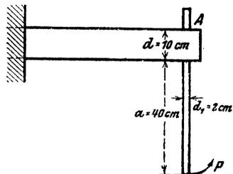
muß die Kraft  $P$  gemacht werden, damit sie a) das Rundholz abdreht ( $K_d = 42$  at); b) den Eisenstab zerbricht ( $K_b = 5000$  at)? Was tritt früher ein, das Abdrehen des Rundholzes oder der Bruch des Eisenstabes?
