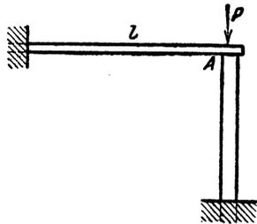
**588.** Die Spannung im Draht einer Telegraphenleitung sei  $S$ . Von welcher Kraft wird der Ständer zu biegen gesucht, wenn der Draht reißt?
