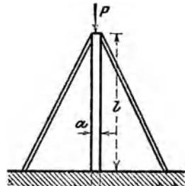
tragen wird, und daß dies mit vierfacher Sicherheit gegen Zerknicken geschieht, wie groß darf die Last gemacht werden?
