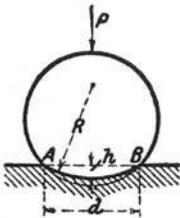
Wenn  $p$  der mittlere Einheitsdruck auf den Eindruckskreis  $AB$  und  $R$  der Krümmungshalbmesser der Eindruckskalotte ist, welche Beziehung besteht zwischen  $p$  und  $R$ ?
