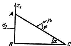
9. Ein kleines Prisma, dessen Querschnitt ein rechtwinkliges Dreieck  $ABC$  ist, wird an der Seitenfläche  $AB$  durch eine Zugspannung  $\sigma_1 = 80$  at und durch eine Schubspannung  $\tau_1 = 60$  at beansprucht. Der Winkel  $\alpha$  ist  $30^\circ$ . Man berechne die Spannung  $p$  der Seitenfläche  $AC$  und den Neigungswinkel  $\varphi$  der Spannung gegen  $AC$ .
