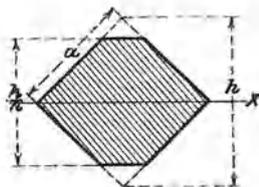
**\*119.** Ermittle Trägheitsmoment und Widerstandsmoment eines Quadrates von der Seitenlänge  $a$ , dessen obere und untere Ecke abgestumpft ist, für die Achse  $X$ , als Funktion von  $n$ , wenn  $\frac{h}{n}$  die Höhe
