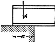
73. Der Auflagerdruck eines Trägers von  $b = 30 \text{ cm}$  Breite ist  $A = 8 \text{ t}$ . Auf welche Länge  $x$  muß der Träger aufliegen, wenn als zulässige Druckspannung für Ziegel-mauerwerk  $k = 5 \text{ at}$  angesetzt wird?
