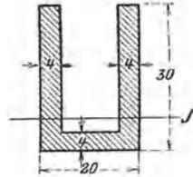
264. Ein Träger von  $l = 2,5$  m freier Länge (Enden eingespannt) und nebenstehendem Querschnitt (Abmessungen in mm) trägt in der Entfernung  $a = 0,8$  m vom Auflager eine Last  $P$ . Wie groß darf diese mit Rücksicht auf das Eigengewicht des Trägers sein, wenn das Einheitsgewicht  $\gamma = 7,8$  und die zulässige Biegungsspannung  $k_b = 1000$  at beträgt? Wie groß ist die Durchbiegung unter  $P$  mit Rücksicht auf das Eigengewicht? ( $E = 2 \cdot 10^6$  at.)
