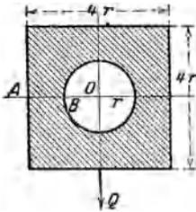
**366.** Ein ausgehölter quadratischer Querschnitt von nebenstehenden Verhältnissen wird einer Querkraft ausgesetzt. Man ermittle die Spannung in einem Punkte der Schichte A B.
