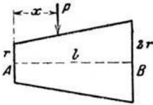
**\*233.** Ein Kegelstutz von der Länge  $l$  und den Halbmessern  $r$  und  $2r$  liegt in A und B frei auf und wird durch P belastet. Bei welcher Stellung  $x_1$  der Last treten die größten Spannungen auf? Wie groß ist die größte Spannung?
