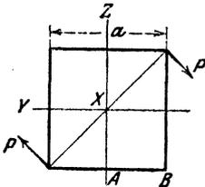
**416.** Ein quadratischer Querschnitt wird von einem Kraftpaar  $PP$  beansprucht. Wie groß sind die Hauptspannungen des Punktes  $A$ , wie sind sie gerichtet, und in welcher Ebene liegen sie?
