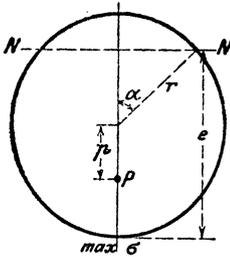
Linie NN und die größte Randspannung max  $\sigma$ .
