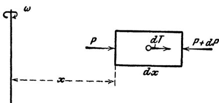
Ist ferner  $m$  die Masse der ganzen Feder,  $dm = \frac{m}{l} dx$  jene des kleinen Stückes.,  $\xi$  die Änderung von  $x$  durch die Fliehkraft, so ist diese:  $dm \cdot (x + \xi)\omega^2 = dT$  und aus  $-dP + dT = 0$ :
