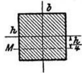
**385.** Zwei gleiche Balken sind einseitig eingespannt und am Ende belastet. Ihre Enden sind verschraubt. Wie groß ist die Schubspannung  $\tau$  und die Schubkraft  $S$  zwischen den Balken? Wie groß muß der Schraubendurchmesser  $d$  gemacht werden, wenn die Spannung  $k_s$  zulässig ist?
