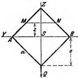
**\*370.** Ein auf der Spitze stehendes Quadrat wird in Richtung einer Diagonale von einer Querkraft beansprucht. Man suche Ort und Größe der größten Randspannung, sowie die Größe der Schubspannung in A und B.
