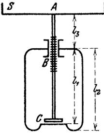
**502.** Bei der Schwungradpresse wird eine Scheibe  $S$  von einem Schwungrad in rasche Umdrehung versetzt und hierdurch die Schraubenspindel  $ABC$  mit großer Kraft nach abwärts gedrückt, derart, daß bei  $C$  Prägungen in Metall stattfinden können. Wenn  $P$  der bei  $A$  übernommene Preßdruck ist, wieviel Formänderungsarbeit muß die Spindel und der Rahmen der Presse aufnehmen können?
