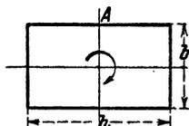
**424.** An der Stelle A wird sowohl durch die Biegung als auch durch die Drehung die Maximalspannung entstehen, und zwar die Biegungsspannung
