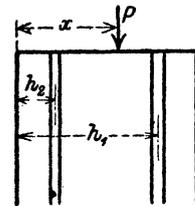
**456.** Die nebenan in Aufriß und Grundriß dargestellte, mit zweifacher Eiseneinlage versehene Säule wird von einer Drucklast beansprucht. Welche größte Entfernung  $x$  vom
