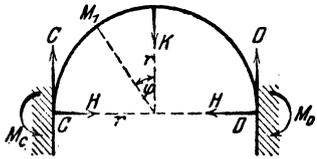
561. Durch Anbringung der unbekanntten Hilfskraft  $K$  trenne man die Konstruktion in nebenan gezeichnete Art. Es ist dann nach den Gleichungen 59 und 64:
