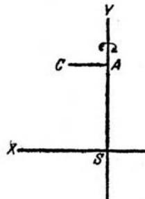
$\Rightarrow J_x, AC = J_{xy}$  und  $AC \perp SA$ . Man zeige, daß  $SC$  die Null-Linie des Querschnittes ist.
