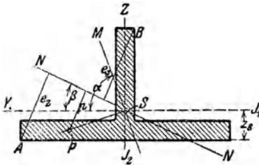
Nach Gleichung 35 ist  $\text{tg } \beta = \frac{J_1}{J_2} \text{tg } \alpha$ , daraus  $\beta = 45^\circ 28' 25''$ .
