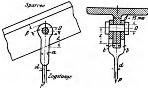
467. Drei Stangen aus Schweiß-eisen von  $d = 4$  cm Dicke sind durch einen Schraubenbolzen vom Durchmesser  $D$  miteinander verbunden und im Gleichgewicht. Die mittlere Stange wird von einer Kraft  $P$  beansprucht, die zwischen 8000 kg Druck und 20 000 kg Zug schwankt. Man berechne die Breiten  $a$  und  $b$  der Stangen für sicheres Tragen, ferner den Durchmesser  $D$  und die Ringbreite  $\beta$ .
