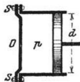
93. Der Deckel des Dampfzylinders in voriger Aufgabe ist angeschraubt. Die Schrauben S sind fest angezogen, so daß in den Schraubenspindeln bedeutende Zugspannungen auftreten. Wenn nun im Innern des Zylinders der Dampfdruck  $p$  auftritt, wird er die Spannungen in den Schraubenspindeln vergrößern oder verkleinern?
