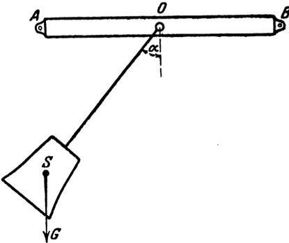
**\*582.** In der Mitte eines Trägers  $AB$  ist eine Glocke vom Gewicht  $G$  aufgehängt, die bei ihren Schwingungen um den Winkel  $\alpha$  von der Vertikalen abweicht. Wie groß ist das Biegemoment und die Achsialkraft, welche die Glocke in  $O$  hervorruft, und bei welcher Stellung der Glocke wird die Spannung im Träger am größten? Von den entstehenden Querkraften im Träger soll abgesehen werden.
