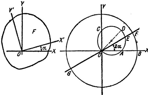
Von einer Fläche  $F$  seien in bezug auf einen Punkt  $O$  die Trägheitsmomente  $J_x$   $J_y$  und das Zentrifugalmoment  $J_{xy}$  gegeben; um die Größen  $J_x'$   $J_y'$   $J_{xy}'$  auch für das um  $\alpha$  gedrehte Achsenkreuz  $X'Y'$  zu gewinnen, mache man
