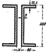
**342.** In welchem Verhältnis steht die Tragfähigkeit einer Säule aus Flußeisen von 2,5 m Länge und nebenstehendem Querschnitt, wenn die beiden durch die XX-Linie getrennten Hälften des Querschnittes das eine Mal fest miteinander verschraubt sind, das andere Mal jede Hälfte von der anderen unabhängig ist. Das untere Ende der Säule ist eingemauert, das obere frei. (Abmessungen in mm.)
