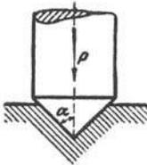
82. Um die Härte eines Körpers zu messen, wird nach der Ludwigschen Kegeldruckprobe ein Stahlkegel von der Öffnung  $2\alpha = 90^\circ$  in die ebene Oberfläche des Körpers eingepreßt. Wie groß ist der Druck auf die Flächeneinheit des Körpers, wenn die Reibung am Kegelmantel berücksichtigt wird?
