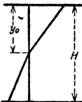
450. Der Beton eines Balkens von rechteckigem Querschnitt (ohne Eisen) hätte eine konstante Elastizitätszahl  $E_{bd}$  für Druck und eine andere, ebenfalls konstante Elastizitätszahl  $E_{bz}$  für Zug. Das Verhältnis der beiden Zahlen sei bekannt. Man suche die Entfernung  $y_0$  der Null-Linie von der Druckkante.
