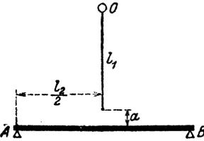
279. Ein in A und B frei aufliegender Träger von der Länge  $l_2$  wird in seiner Mitte mit  $P$  belastet und in O an einer Stange von der Länge  $l_1$  aufgehängt. Welcher Teil  $P_1$  der Last  $P$  wird von der Stange getragen und welcher Teil  $P_2$  vom Träger? Wie groß ist die Durchbiegung  $f$  in der Mitte des Trägers? (Ohne Berücksichtigung der Eigengewichte.)
