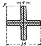
**311.** Zwei flüßeiserne Stäbe von gleichem Querschnitt werden aneinander befestigt und durch eine Zugkraft  $P$  beansprucht, die abwechselnd auf ihre Hälfte herabsinkt. Wie groß darf  $P$  sein mit Rücksicht auf die zulässige Spannung, wenn diese  $\frac{2}{7}$  der Arbeitsfestigkeit sein soll? (Abmessungen in mm.)
