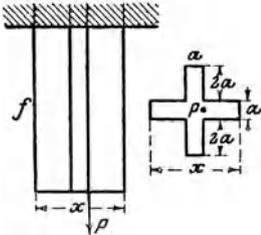
**312.** Ein Stab von kreuzförmigem Querschnitt wird an seinem unteren Ende in angedeuteter Weise exzentrisch belastet. Die Breite  $x$  ist unbekannt. Wie groß muß das Verhältnis  $\frac{x}{a} = z$  gemacht werden, wenn die Spannung in der Faser  $f$  Null sein soll?
