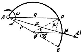
573. Es sei P die Stelle des Drahtes, für welche wir das Biegemoment suchen wollen, M ein Element des Drahtes zwischen P und B, seine Masse
