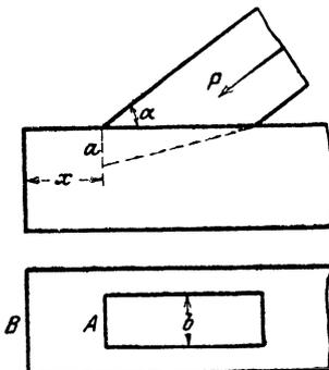
**359.** Der Fuß eines unter  $\alpha = 30^\circ$  geneigten Holzsparrens drückt mit der Kraft  $P = 2000$  kg in das Ende eines horizontalen Balkens und sucht das Stück AB abzuscheren. Man berechne die notwendige, dem Sparrenfuß noch vorgelagerte Länge  $x$  des Balkens, wenn die Tiefe der Verschneidung  $a = 4$  cm, ihre Breite  $b = 6$  cm und  $k_s = 6$  at die zulässige Schubspannung des Holzes ist.
