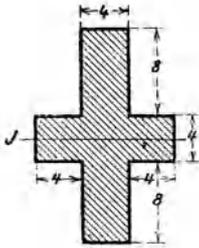
186. Die Speiche eines Rades hat kreuzförmigen Querschnitt von nebenstehenden Abmessungen in cm und eine Länge von  $2$  m; das eine Ende steckt in der Nabe des Rades, das andere Ende wird durch die Umfangskraft des Rades belastet. Wie groß darf diese Umfangskraft  $P$  sein, wenn die zulässige Biegungsspannung  $k_b = 200$  at nicht überschritten werden soll?
