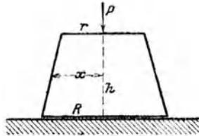
\*87. Ein Kegelstutz von der Höhe  $h$ , den Halbmessern  $R$ ,  $r$  und dem Einheitsgewicht  $\gamma$  wird mit  $P$  belastet. Man suche den Halbmesser  $x$  des am wenigst beanspruchten Querschnittes.
