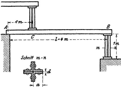
Druck einer Säule mit 1000 kg und überdies mit 500 kg für jeden Meter Länge gleichförmig belastet ist. In B stützt sich der Balken auf eine schweißeiserne Säule von 1 m Länge, deren Querschnitt aus vier gleichen Winkelisen zusammengesetzt ist.
