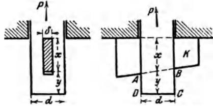
361. Eine oberflächliche Berechnung der Schubspannungen nimmt diese in allen Stellen des Querschnittes  $F$  gleich groß an, und zwar  $\tau = \frac{Q}{F}$ . Man untersuche, ob in einem rechteckigen Querschnitt Stellen vorkommen, deren Schubspannung wirklich diese Größe besitzt.
