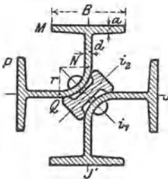
**138.** J. M. Latiner, Chicago, empfahl Säulen-Querschnitte aus gebogenen I-Eisen nach nebenstehender Anordnung. Man soll aus den Abmessungen  $B$ ,  $a$ ,  $d$ , der ursprünglichen Höhe  $H$  der I-Eisen, dem Krümmungshalbmesser  $r$  und den Hauptträgheitsmomenten  $i_1$  und  $i_2$  des inneren kleinen I-Eisens die Hauptträgheitsmomente des Querschnittes ermitteln.
