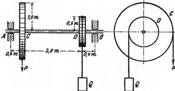
abwärts, an letzterem befindet sich die Last  $Q$  im Gleichgewicht. Berechne den Durchmesser  $d$  der eisernen Welle unter Zugrundelegung folgender zulässigen Spannungen: für Biegung  $k_b = 600$  at, für Drehung  $k_d = 240$  at.
