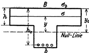
worin  $\sigma = \sigma_b \cdot \frac{y}{y_0}$ ,  $dF_1 = B \cdot dy$ ,  $dF_2 = b \cdot dy$  und  $\sigma_b$  die
