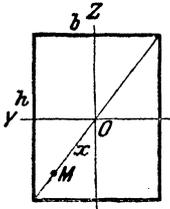
**\*415.** Ein rechteckiger Querschnitt ( $b$  und  $h$ ) wird von einem Drehungsmoment beansprucht. Man stelle die Spannung  $\tau$  eines beliebigen Punktes  $M$  der Diagonale  $d$  als Funktion der Entfernung  $x$  vom Mittelpunkte  $O$  dar. In welchem Punkte der Diagonale erreicht die Spannung den größten Wert? Wie groß ist dieser?
