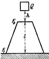
**\*593.** Auf eine abgestumpfte Pyramide von der Höhe  $l$  und den Endflächen  $F_0$  und  $F_1$  fällt aus der Höhe  $h$  eine Last  $Q$ . Man berechne den dynamischen Faktor.
