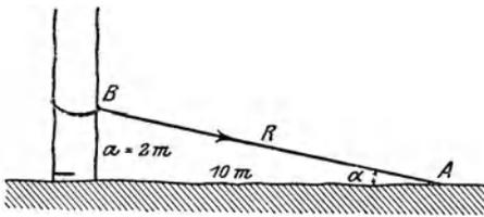
und dicht über dem Boden zur Hälfte durchsägt ist. Ein Seil ist in der Entfernung  $a = 2\text{ m}$  vom Boden befestigt und wird von  $A$  aus mit der Kraft  $R$  gezogen. Wie
