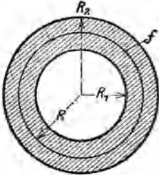
\*457. Die Abbildung zeigt den Querschnitt einer Esse aus Beton, die eine Eisenrinne vom Halbmesser  $R$  besitzt. Die Esse wird in Richtung ihrer Achse von einer Drucklast beansprucht. Welchen Abstand  $p$  darf die Last  $P$  von der Achse haben, wenn nur Druckspannungen entstehen sollen?
