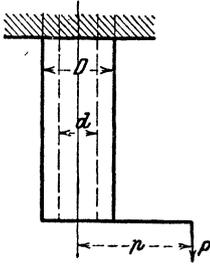
**303.** Ein Stab, dessen Querschnitt ein Kreisring ist (äußerer Durchmesser  $D$ , Durchmesserverhältnis  $\frac{d}{D} = \delta$ ) wird am unteren Ende mit der Last  $P$  belastet. Um welche Größe  $p$  darf man die Last aus der Stabmitte rücken, wenn die zulässige Spannung für Zug  $k_z$  nicht überschritten werden soll?
