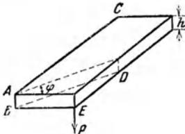
200. Ein Balken, dessen Seite  $ABC$  eingemauert ist, wird an der Kante  $E$  mit  $P$  belastet. Welchen Winkel  $\varphi$  bildet die meistgespannte Fläche  $ABD$  mit  $AE$ , und wie groß ist die in ihr entstehende größte Spannung?
