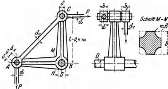
aus  $m$  und  $B$  (speziell für  $m = 0,4$ ); e) die notwendige Stärke  $B$  für zehnfache Sicherheit gegen Knicken.
