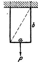
4. Ein Stab von quadratischem Querschnitt  $a^2$  ragt ein kurzes Stück b aus der Mauer hervor und wird an seinem Ende durch eine Querkraft Q beansprucht, die sich gleichförmig über die Endfläche verteilt. Man ermittle die Normalspannung  $\sigma$  in der Diagonalebene AB.
