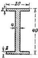
214. Ein gewalzter Träger von nebenstehendem Querschnitt wird das eine Mal auf dem 20 cm breiten Flansch gelagert, das andere Mal derart, daß die Trägerhöhe 40 cm horizontal liegt. Welche freie Länge müßte der Träger in diesen beiden Fällen bekommen, wenn er nur infolge seines Gewichtes zerbrechen sollte? (Biegungsfestigkeit  $K_b = 5000$  at, Einheitsgewicht  $\gamma = 7,8$ , Abmessungen in cm.)
