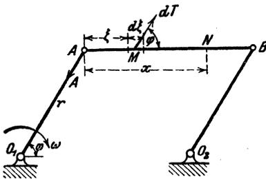
580. Da die Stange AB eine krummlinige Translationsbewegung ausführt, so hat jeder ihrer Punkte M dieselbe Beschleunigung wie A, also  $\gamma = r\omega^2$  unter dem Winkel  $180^\circ - \varphi$  gegen AB geneigt. Die Trägheitskraft des Massenelementes in M ist also
