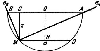
17. Die Hauptspannungen eines Punktes M:  $\sigma_1 = OA$  und  $\sigma_2 = OB$  werden auf der X-Achse eines rechtwinkligen Achsenkreuzes von O aus aufgetragen. Der Punkt M selbst werde so gezeichnet, daß die Richtungen seiner Hauptspannungen durch A und B gehen. Zieht man dann über AB einen
