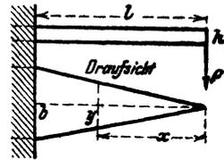
\*543. Man bestimme bei dem in Aufgabe 510 angegebenen Belastungsfall die Durchbiegung des Trägers unter der Last  $P$ .
