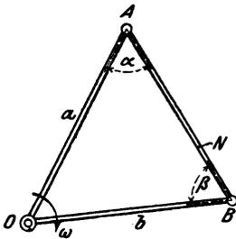
**\*581.** Ein Stab  $AB = l$  vom Gewicht  $G$  ist durch zwei andere Stäbe  $a$  und  $b$  mit dem Gelenk  $O$  verbunden und dreht sich um diesen Punkt in glatter, horizontaler Ebene mit konstanter Winkelgeschwindigkeit  $\omega$ . Man berechne das Biegemoment  $M$  an irgendeiner Stelle  $N$  des Stabes sowie die dort auftretende Achsialkraft  $N$  und Querkraft  $Q$ . An welcher Stelle wird  $M$  am größten,  $N$  und  $Q$  am kleinsten?
