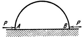
**\*552.** Ein elastischer, dünner Ring ist an zwei diametral gelegenen Stellen A und B aufgeschnitten und mit Gelenken versehen. An den Enden des Durchmessers CD drücken zwei gleiche Kräfte P. Um wieviel verändern sich die Längen der Durchmesser AB und CD?
