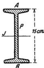
**316.** Ein eiserner Träger, Deutsches Normalprofil Nr. 15, mit der Länge  $l = 4,5$  m wird in Richtung seiner Länge mit  $P = 10$  t gedrückt. Welche größte Exzentrizität  $p$  darf der Kraftangriff in der vertikalen Mittellinie erhalten, wenn die größte entstehende Spannung 1000 at nicht überschreiten soll? (Elastizitätszahl  $E = 2 \cdot 10^6$  at, Trägheitsmoment  $J = 734$  cm<sup>4</sup>, Fläche des Querschnittes  $F = 20,4$  cm<sup>2</sup>.)
