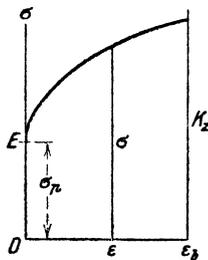
**\*504.** Wie wird die Formänderungsarbeit eines über die Proportionalitätsgrenze hinaus belasteten Stahlstabes zu berechnen sein, wenn hierfür das Spannungsgesetz  $\sigma^5 = C \epsilon$  zugrunde gelegt wird? (Leitzmann, Zeitschr. Ver. deutsch. Ing. 1900.)
