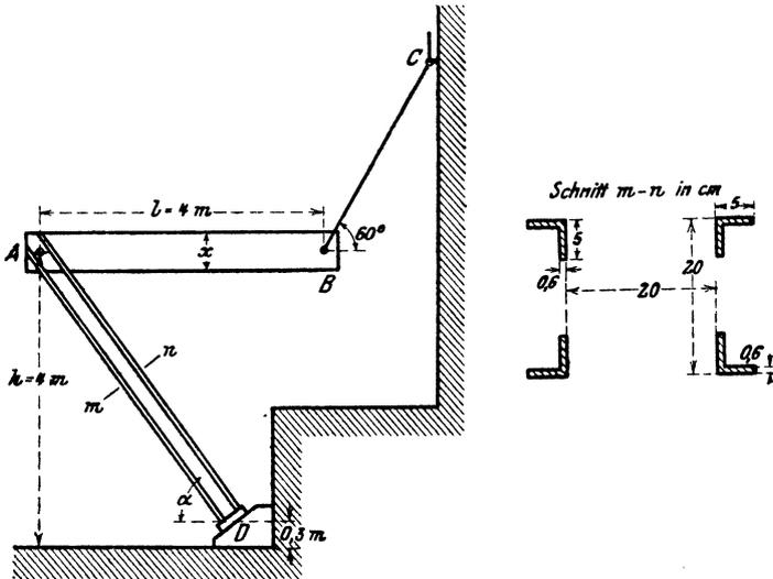
der Strebe gegeben werden, damit sie rein auf Druck (Knickung) beansprucht wird? b) Welchen Auflagerdruck darf der Balken in A ausüben, daß die zulässige Druckspannung  $k = 1000 \text{ at}$  in der Strebe nicht überschritten wird? c) Welche Last  $q$  für die Längeneinheit kann der Balken tragen? d) Welche Höhe  $x$  muß der Balken bekommen, wenn seine Breite  $b = 20 \text{ cm}$  und seine
