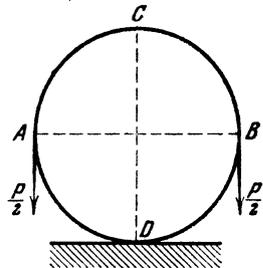
Der Ring ist in D unterstützt. Man suche die Verlängerung bzw. Verkürzung der Durchmesser AB und CD, sowie das größte Biegemoment im Ringe.
