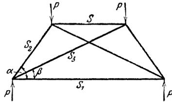
\*521. Ein aus sechs Stäben mit gleichem Querschnitt gebildetes Trapez wird von vier gleichen Kräften P belastet. Man suche die Spannungen in den Stäben.
