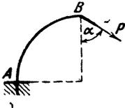
**\*547.** Ein dünner, elastischer Stab, der die Form eines Kreisquadranten hat, wird in  $B$  von einer beliebig gerichteten Kraft  $P$  beansprucht. Man suche die horizontale und die vertikale Verschiebung von  $B$ .
