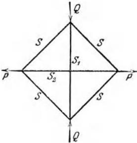
**\*518.** Ein aus sechs Stäben bestehendes quadratisches Fachwerk wird an den Ecken durch vier paarweise gleiche Kräfte  $P$  und  $Q$  beansprucht. Der Querschnitt und die Elastizitätszahl sind überall gleich. Es sind die Spannungen  $S, S_1, S_2$  zu berechnen.
