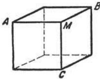
49. Die Kanten eines rechtwinkligen Parallelepipeds haben folgende Längen:  $AM = 2,0 \text{ cm}$ ,  $BM = 1,6 \text{ cm}$ ,  $CM = 2,8 \text{ cm}$ ; die Seitenflächen werden von folgenden Kräften beansprucht:  $BC$  durch  $670 \text{ kg}$  Zug,  $CA$  durch  $940 \text{ kg}$  Druck,  $AB$  durch  $730 \text{ kg}$  Druck. Die Elastizitätszahl ist  $E = 2 \cdot 10^6 \text{ at.}$ ; das Verhältnis der Längsdehnung
