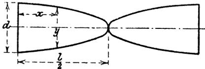
**388.** Der linke Auflagerdruck ist  $\frac{1}{6} q l$ , das Biegemoment in der Mitte des Trägers  $\frac{1}{16} q l^2$ , die größte Biegespannung an
