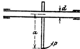
**399.** Durch das Ende eines 1,0 m langen, 10 cm starken Rundholzes wird ein 2 cm dicker, quadratischer Eisenstab gesteckt, so daß 0,4 m desselben hervorstehen. Am Ende des Stabes sucht eine Kraft  $P$  das Rundholz zu drehen. Wie groß
