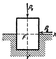
10. Ein kleiner prismatischer Körper mit dem Querschnitt  $F = 1 \text{ cm}^2$  wird in der gezeichneten Weise von einer Druckkraft  $P_1$  und einer Scherkraft  $P_2$  beansprucht. Wenn sich diese Kräfte gleichförmig über  $F$  verteilen, wie groß sind dort die Hauptspannungen und welche Winkel schließen ihre Ebenen mit der Richtung  $X$  ein? Es ist
