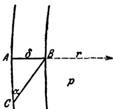
7. Die Abbildung zeigt ein Stück des Querschnittes einer fußeisernen Granate von der Stärke  $AB = \delta$ , dem Innenhalbmesser  $r$  und dem Innendrucke  $p$ .  $ABC$  sei ein Splitter dieser Granate. Unter welchem Winkel  $\alpha$  wird sich die Splitterung ausbilden, wenn  $r$  sehr groß gegen  $\delta$  ist?
