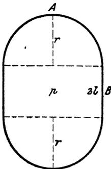
\*558. Ein dünnwandiges Gefäß hat nebenstehenden Querschnitt. Es ist einem inneren Druck  $p$  für die Längeneinheit des Umfanges ausgesetzt. Man berechne Ort und Größe des größten Biegemomentes der dünnen Wand, sowie die Verschiebungen der Punkte A und B. (M. Westphal, Zeitschr. Ver. Deutsch. Ing. .1909.)
