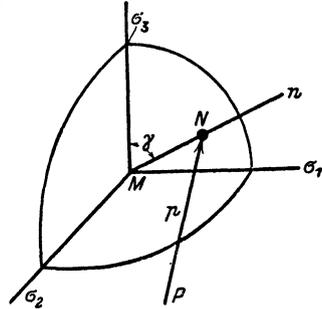
25. Die Hauptspannungen eines Punktes M:  $\sigma_1 = OA$ ,  $\sigma_2 = OB$ ,  $\sigma_3 = OC$  werden auf der X-Achse eines rechtwinkligen Achsenkreuzes von O aus aufgetragen. Um die Gesamtspannung p einer beliebigen Ebene des Punktes M zu finden, gibt O. M o h r (Zeitschr.
