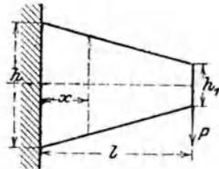
**\*193.** Ein an seinem oberen Ende von einer Kraft  $P$  beanspruchter Leitungsmast hat eine linear veränderliche Breite  $2z$ . Sein Querschnitt hat nebenan gezeichnete Form. Wenn  $2a$  seine Breite am oberen Ende ist, wie groß muß diese in dem meist beanspruchten Querschnitt gewählt werden? Wo ist dieser?
