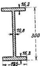
188. Ein gewalzter Träger von nebenstehendem Querschnitt soll eine derartige freie Länge bekommen, daß die Durchbiegung  $f$  am Ende  $2$  cm beträgt. Wie groß muß diese Länge gemacht werden, wenn außer dem Eigengewicht keine Last vorhanden ist? (Einheitsgewicht  $\gamma = 7,8$ ; Elastizitätszahl  $E = 2 \cdot 10^6$  at; Abmessungen in mm.)
