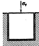
57. Ein Eisenstück von quadratischem Querschnitt  $a^2$ , das von zwei gleichen Kräften  $P$  zusammengepreßt ist, wird von zwei miteinander verschraubten Balken derart umschlossen, daß es seine Breite  $a$  nicht ändern kann. Man drücke die in den Schrauben auftretende Spannung  $s$  durch  $P$  und die Abmessungen  $a, b, d$  aus.
