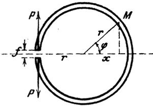
**\*546.** Eine Kreisfeder ist an einer Stelle durchgeschnitten und wird dort um  $f$  geöffnet. Welche Kräfte  $P$  müssen dazu angewendet werden? (Mit Berücksichtigung der Achsialkräfte.)
