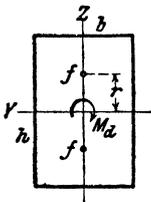
**\*436.** Ein auf Verdrehung beanspruchter Holzbalken wird seiner Länge nach von zwei Rundeisen durchzogen, deren Querschnitt  $f$  gleich dem 36. Teil des Balkenquerschnittes ist. Der wievielte Teil des ganzen Verdrehungsmomentes  $M_d$  wird von den beiden Rundeisen aufgenommen?
