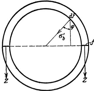
**460.** Die rechten Seiten der Ringe werden durch P in das Lager gedrückt. Es muß dann die Gleichung erfüllt sein:
