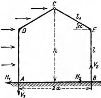
Man berechne die horizontalen Schubkräfte  $H_1$  und  $H_2$ , die vertikalen Auflagerdrücke  $V_1$  und  $V_2$ , die Einspannungsmomente  $M_1$  und  $M_2$  in A und B, endlich die Einspannungsmomente  $M_3$  und  $M_4$  in in D und E, und den Gelenkdruck in C. Alle Stäbe haben gleichen Querschnitt; die Elastizitätszahl ist durchaus die gleiche.
