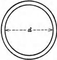
\*459. Eine Betonsäule, die in Richtung ihrer Länge  $l$  eine Druckspannung  $\sigma_b$  aufzunehmen hat, wird von einem eisernen Ringe umschürt. Man berechne die im Ringe auftretende Zugspannung  $\sigma_e$  sowie die in der Betonsäule in Richtung ihres Durchmessers auftretende Druckspannung  $\sigma'_b$ .
