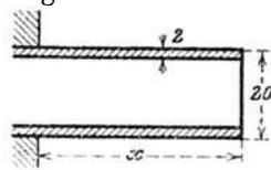
182. Um die Tragfähigkeit einer Röhre AC, die bei C belastet wird, zu vermehren, wird in das Innere ein gut passender Holzkern geschoben, der bis B reicht.
