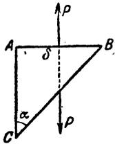
$\frac{pr}{\delta} \sin \alpha \cos \alpha$ . Die Splitterung wird sich unter jenem Winkel ausbilden, für den die Schubspannung am größten wird, also unter  $\alpha = 45^\circ$ .
