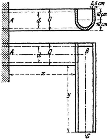
beide Röhren, die geschlossene und die oben offene, sind mit Wasser gefüllt. Die zulässigen Spannungen des Rohres AB seien  $k_z = 250$  at Zug,  $k_s = 200$  at Schub; die zulässige Biegungsspannung im Rohr BC sei  $k_b = 300$  at. Wie lang ( $y$ ) darf der Ansatz gemacht werden? Wie lang ( $x$ ) darf das Rohr gemacht werden? (Einheitsgewicht des Gußeisens  $\gamma = 7,5$ .)
