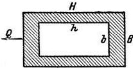
**367.** Ein Querschnitt besteht aus einem hohlen Rechteck, wobei  $b : B = h : H = n : 1$ . Wenn dieser Querschnitt von einer Querkraft beansprucht wird, wie verhält sich der für die Berechnung der größten Schubspannung maßgebende reduzierte Querschnitt  $F_0$  zum wirklichen Querschnitt  $F$ ? (Vergleiche Gleichung 103.)
