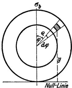
458. In einem Flächenstück  $dF = \rho d\rho d\varphi$  der Betonfläche sei  $\sigma$  die Spannung; dann ist
