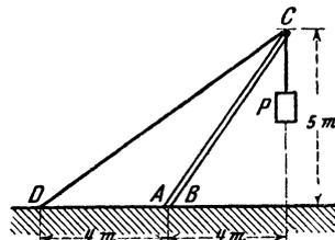
Last von  $P = 2$  t. Berechne den Durchmesser  $d$  der Stange (zulässige Zugspannung  $k_z = 600$  at), sowie die Stärke der Säulen bei elffacher Sicherheit gegen Zerknicken.
