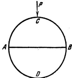
**\*551.** Ein schwerer, dünner Halbzylinder ruht auf einer horizontalen Ebene. An den Rändern sollen zwei gleich große, horizontale Kräfte P derart angebracht werden, daß sie die Vergrößerung des Durchmessers AB durch das Gewicht des Halbzylinders verhindern. Wie groß muß P gemacht werden?
