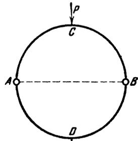
**\*553.** An den Enden A und B des Durchmessers eines elastischen, dünnen Ringes hängen zwei gleiche Lasten  $\frac{P}{2}$ .
