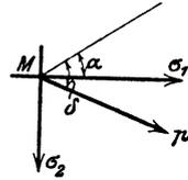
13. Ein Punkt M besitzt die Hauptspannungen  $\sigma_1$  und  $\sigma_2$ , während die dritte  $\sigma_3 = 0$  ist. Man trägt die Normalspannung  $\sigma$  jeder durch  $\sigma_3$  gehenden Ebene auf ihrer Normale von M aus auf, derart, daß  $MN = \sigma$  ist. Man suche den Ort des Endpunktes N in Polarkoordinaten.
