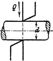
**354.** Welche Schubkraft  $Q$  muß von den Backen einer Eisenschere ausgeübt werden, wenn ein 4 cm starkes Rundeisen durchschert werden soll, dessen Schubfestigkeit  $K_s = 3500$  at ist?
