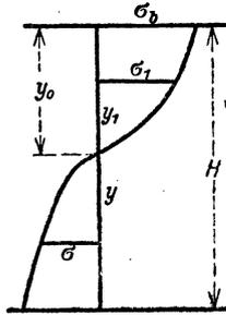
**452.** Ein Eisenbetonträger von nebenan stehendem Querschnitt wird von einem Biegemoment  $M$  beansprucht. Der Beton gehorcht dem in Aufgabe 450 angeführten Gesetze. Man suche die größte Druckspannung im Beton.
