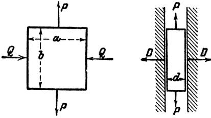
58. Eine rechteckige Platte von der Dicke  $d$  liegt zwischen zwei festen parallelen Flächen, die sie berühren. Welchen Druck  $D$  übt sie auf diese Fläche aus, wenn die Platte an ihren Seiten von zwei Zugkräften  $P$  und zwei Druck-
