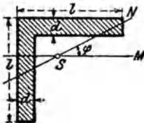
170. Ein gleichschenkliges Winkeleisen hat in bezug auf seinen Schwerpunkt folgende Hauptträgheitsmomente:  $J_1 = 285$  cm<sup>4</sup>,  $J_2 = 75$  cm<sup>4</sup>. Die Achse  $M$  des Biegemomentes ist parallel zu einem Schenkel. Welchen Winkel  $\varphi$  schließt die Biegungsachse  $N$  mit  $M$  ein?
