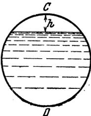
\*560. Ein zylindrisches Gefäß von der Länge  $l$  ist zum Teil mit schwerer Flüssigkeit gefüllt. Man berechne die Achsialkräfte und Biegemomente an den Stellen C und D unter Vernachlässigung des Einflusses, den die Abschlußböden des Gefäßes ausüben.
