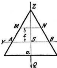
**\*369.** Ein gleichseitiges Dreieck wird von einer Querkraft  $Q$  beansprucht. Wie groß ist die Randspannung in A und B? An welchen Stellen findet die größte Spannung statt, und wie groß ist sie?
