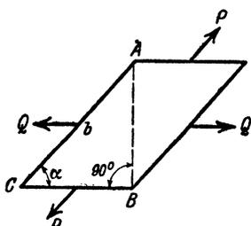
8. Ein kleines Prisma von der Höhe  $a$ , dessen Querschnitt nebenstehendes Parallelogramm ist, wird von vier gleichen Kräften  $P$  und  $Q$  beansprucht. Man suche die Normalspannung  $\sigma$  und die Schubspannung  $\tau$  der Diagonalebene  $AB$ .
