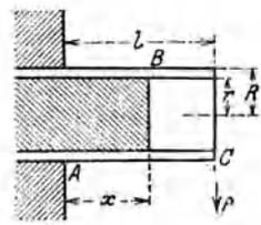
183. Zwei gleich starke Balken sind an dem einen Ende durch mehrere Schrauben an einem starken Klotz befestigt, an dem anderen Ende durch eine  $1\text{ cm}$  starke Schraube miteinander verbunden. Welche Erscheinung tritt bei fortwährendem Anziehen der rechten Schraube früher ein: der Bruch der Balken oder das Zerreißen der Schraubenspindel? ( $K_b = 470\text{ at}$  Biegezugfestigkeit des Holzes,  $K_z = 4000\text{ at}$  Zugfestigkeit des Eisens vorausgesetzt.)
