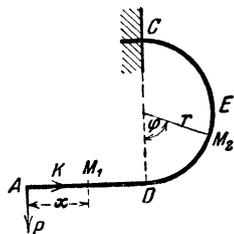
**555.** Der Draht bleibt der Symmetrie wegen in C horizontal; das Stück ADEC kann also wie in C eingespannt betrachtet werden. Das Biegemoment einer Stelle zwischen A und D ist:  $M_1 = -Px$ ; jenes einer Stelle des Halbkreises ist
