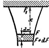
107. Nennt man  $G_x$  das Gewicht des tragenden Körpers unterhalb des Querschnitts  $F$ ,  $G'_x$  jenes des nicht tragenden Körpers unterhalb  $F$ , so ist für sicheres Tragen
