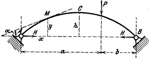
beliebigen Stelle M gleich  $J_0 \sec \alpha$  ist, worin  $J_0$  das Trägheitsmoment im Scheitel C und  $\alpha$  die Neigung der Tangente in M bedeutet.
