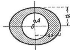
**309.** Ein Träger von nebenstehendem Querschnitt wird in A von einer Last beansprucht, die zur Achse des Trägers parallel ist. Wie groß muß die Breite  $x$  des Steges gemacht werden, wenn der Punkt B keine Spannung erleiden soll?
