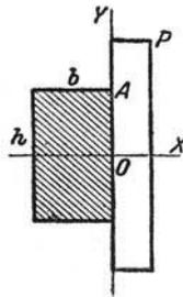
**\*139.** An einen rechteckigen Querschnitt ( $b$ ,  $h$ ) wird symmetrisch ein anderes Rechteck gefügt, ohne daß das Widerstandsmoment in bezug auf die Symmetrale  $O X$  geändert wird. Welche Kurve muß dann der Endpunkt  $P$  des angefügten Rechtecks erfüllen?
