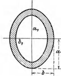
**191.** Ein Träger von  $l = 3$  m Länge und nebenstehendem Querschnitt mit dem Einheitsgewicht  $\gamma = 7,5$  soll am Ende die Last  $P = 3000$  kg sicher tragen. Die zulässigen Spannungen sind 300 at für die Zugseite, 800 at für die Druckseite. Wie groß muß  $x$  gemacht werden, wenn das Eigengewicht berücksichtigt wird?
