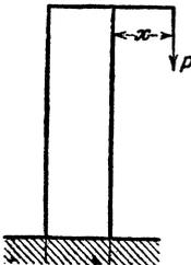
**306.** Ein quadratisch behauener Balken aus Eichenholz von 20 cm Stärke und 4 m Länge soll an seinem oberen Ende mit  $P = 800$  kg belastet werden. Das untere Ende ist eingemauert. Um wieviel ( $x$ ) darf die Last über den Rand des Balkens gerückt werden, wenn fünffache Bruchsicherheit bestehen soll? (Druckfestigkeit  $K = 345$  at, Elastizitätszahl  $E = 103\,000$  at.)
