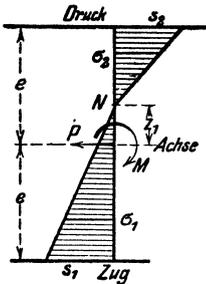
Ist  $b$  die Breite des Rechtecks,  $b dz$  ein Flächenelement im Abstände  $z$  von der Null-Linie,  $\sigma_1$  die dort auftretende Zugspannung,  $\sigma_2$  die Druckspannung, so bestehen folgende Gleichungen:
