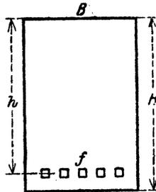
**453.** Ein Eisenbetonträger von demselben Querschnitt wie in Aufgabe 441 werde einem Biegemoment  $M$  ausgesetzt. Der Beton gehorche dem in Aufgabe 450 angeführten Gesetze. Man suche die größten Spannungen im Beton und im Eisen.
