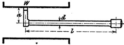
**398.** Eine Welle von  $d = 5 \text{ cm}$  Durchmesser wird von einer Kraft  $P$  gedreht, die am Ende eines Armes  $a = 0,8 \text{ m}$  senkrecht zu Arm und Welle wirkt. Wie groß darf  $P$  höchstens sein, wenn die zulässige Drehungsspannung  $k_d = 500 \text{ at}$  nicht überschritten werden soll?
