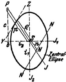
Ist J das Trägheitsmoment des Querschnitts für die Linie PS, so ist  $i = \sqrt{\frac{J}{F}}$  der zugehörige Trägheitshalbmesser. Für die Hauptachsen  $J_1$  und  $J_2$  ist:
