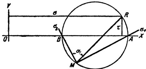
Kreis und nimmt auf diesem einen beliebigen Punkt R an, so sind dessen Koordinaten  $\sigma$  und  $\tau$  die Normal- und die Schubspannung jener Ebene durch M, deren Normale MR ist. Man suche dies zu beweisen. (Mohr, Zeitschr. d. Ver. deutscher Ing. 1900.)
