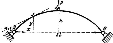
\*565. Ein elastischer Parabelträger, der an den Enden A und B eingespannt ist, wird derart belastet, daß auf jede Längeneinheit der Geraden AB die Belastung q entfällt. Der Querschnitt des Trägers ist unveränderlich. Man berechne die Auflagermomente  $M_1$  und den Horizontalschub H.
