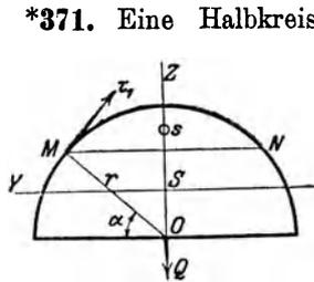
**\*371.** Eine Halbkreisfläche wird von einer Querkraft  $Q$  beansprucht. Wie groß ist die Randspannung  $\tau_1$  an einer beliebigen Stelle des Umfanges? Für
