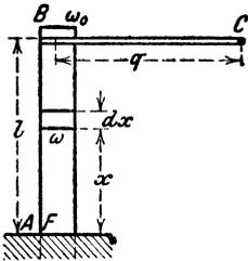
Die durch die ruhende Last  $Q$  erzeugte Formänderungsarbeit ist nach den Gleichungen 131 und 111:
