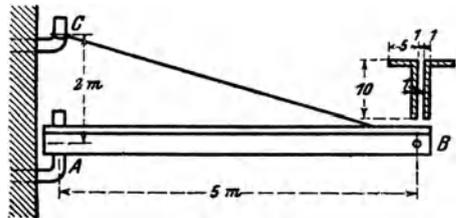
469. Ein Kunstwinkel ABC zum Betrieb einer Pumpe überträgt eine Kraft  $P$ , welche abwechselnd zwischen 2 t und 5 t Zug schwankt. Es ist  $AB \perp BC$ . Die drei Zugstangen, die Welle  $D$  und die Schraubenbolzen  $\delta$  sind aus Schweiß-eisen, der Winkel selbst aus Gußeisen mit kreuzförmigem Querschnitt. Es sollen berechnet werden: a) die zulässigen Spannungen des Schweiß-eisens für Zug
