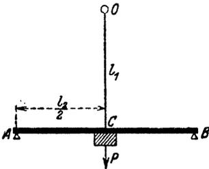
280. Der Träger der vorigen Aufgabe werde noch durch einen anderen frei aufliegenden Balken unterstützt, der senkrecht zur Bildfläche steht, die Länge  $l_3$  hat und mit seiner Mitte in C verschraubt ist. Wie verteilt sich nun die Last  $P$  auf die Stange OC und die beiden Träger, und wie groß ist die Durchbiegung in der Mitte? (Ohne Berücksichtigung der Eigengewichte.)
