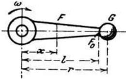
Spannung in allen Punkten gleich  $s$  sein soll?
