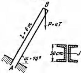
**315.** Der Ausleger eines Kranes hat  $l = 6$  m Länge und einen aus zwei U-Eisen bestehenden Querschnitt, dessen maßgebendes Trägheitsmoment  $J = 16052$  cm<sup>4</sup> und dessen Querschnittsfläche  $F = 117,6$  cm<sup>2</sup> ist. Der Ausleger ist unter  $\alpha = 70^\circ$  geneigt, wird in A eingespannt und in B mit  $P = 4$  t belastet. Man suche Ort und Größe der größten auftretenden Spannungen. ( $E = 2 \cdot 10^6$  at.)
