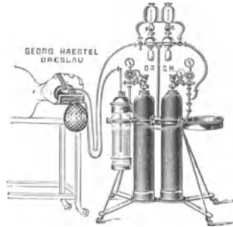
Abb. 109. Der Überdruckapparat nach Tiegel erfordert nur die Verwendung von Sauerstoff.
