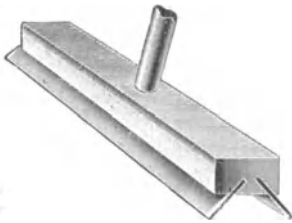
Abb. 79. Gummischieber. In dem hölzernen Querbrett sind 2 fingerdicke Gummipplatten eingefügt.
