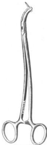
Abb. 291. Zange zum Halten der kleinen Schrauben.
