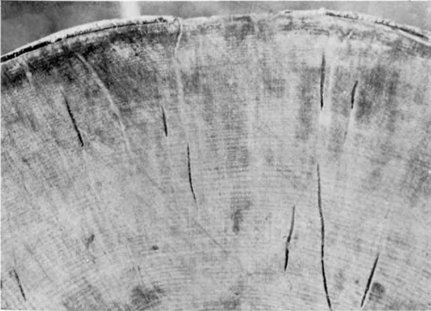
Abb. 87d. Buche, Querschnitt mit Gängen von *Lymexylon dermestoides*.
