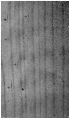
Abb. 11. Radialer Längsschnitt durch Kiefernholz.
