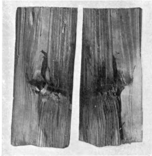
Abb. 166. Aufgespaltenes Stück einer mit Chlorzink imprägnierten Schwelle.
