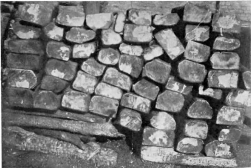
Abb. 155. Imprägnierte durchschnittene Buchenschwellen mit rotem Kern.
