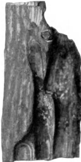
Abb. 131 b. Von der Fingermuschel zerstörtes Kiefernholz aus dem Hafen von Gjedser.  $\frac{3}{4}$  nat. Gr.
