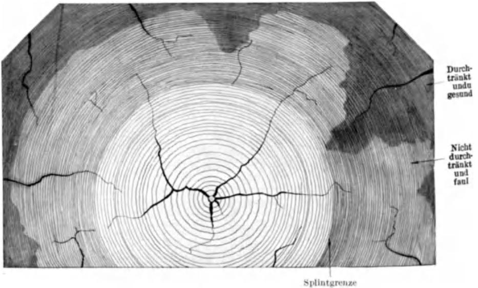
Abb. 156. Nach dem Blytheschen Verfahren imprägnierte Schwelle.
