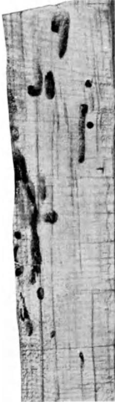
Abb. 96 b. Weide vom Erlenverborgenrüßler befallen. Längsschnitt.
