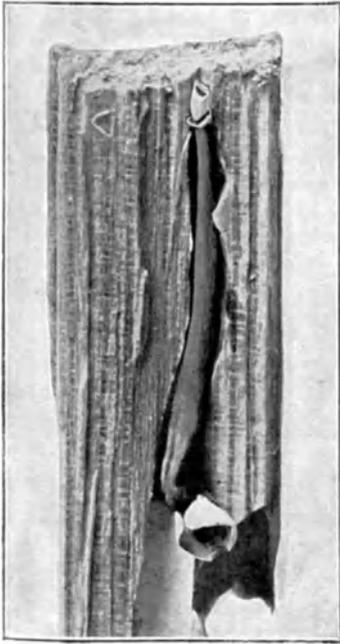
Abb. 132 a. Geöffneter Bohrwurmengang mit Bohrwurm in Kiefernholz aus Wilhelmshaven.
