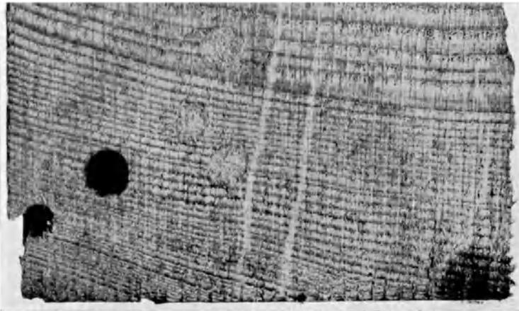
Abb. 122c. Querschnitt durch Kiefernholz mit 2 offenen und 3 mit Bohrmehl verstopften Larvengängen der Kiefernholzwespe. Nat. Gr.
