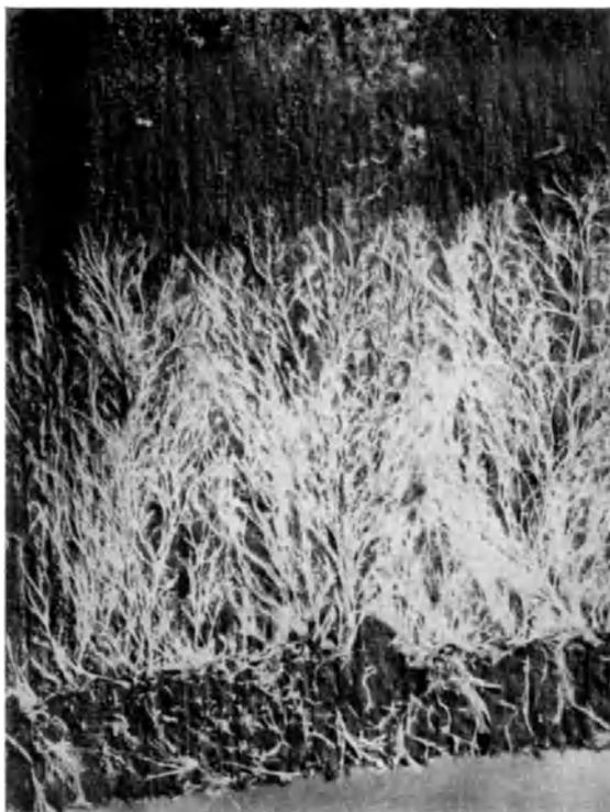
Abb. 72. Myzelien und Stränge von *Paxillus acheruntius* auf der Oberfläche eines befallenen Brettes aus der Einschubdecke. Verkl. Orig.
