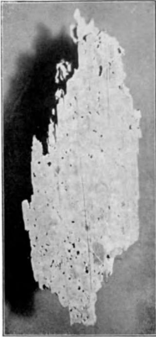
Abb. 132 c. Außenseite eines vom Bohrwurm befallenen Kiefernpfahles.  $\frac{1}{4}$  nat. Gr.
