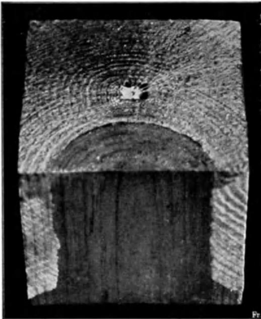
Abb. 193. Mit *Coniophora cerebella* bewachsener Holzwürfel. (Infiziertes Splintholz.)
