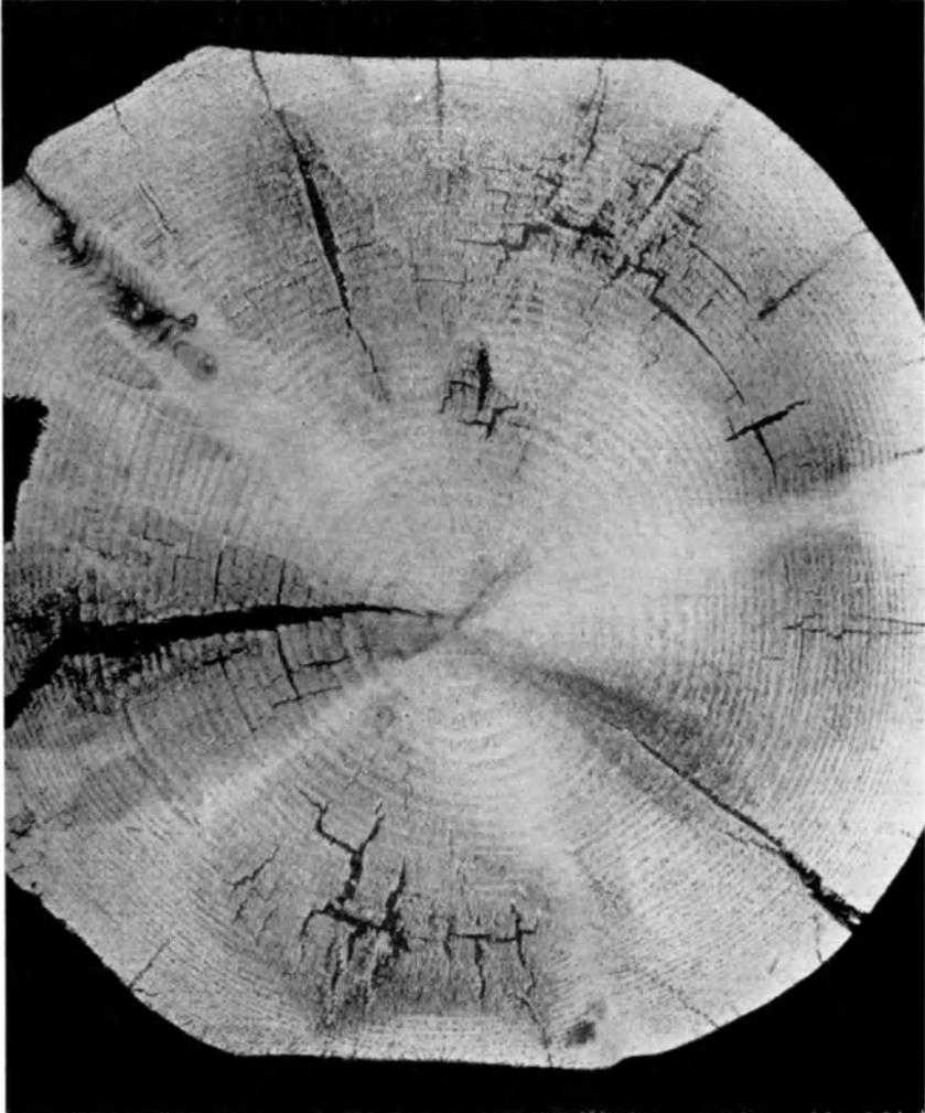
Abb. 79. Lenziteskranker Tannenbalken im Querschnitt. (Aus H. F. III. H.) Verkl.
