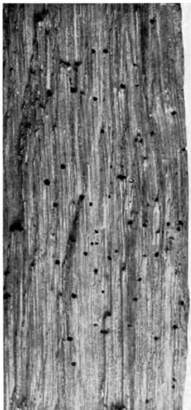
Abb. 88 c. Eiche von *Lymexylon navale* befallen, Rindenseite. Nat. Gr.
