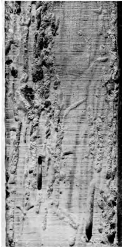
Abb. 110 b. Dachbalken eines Hauses von *Callidium bajulum*-Larven zerstört im Längsschnitt.  $\frac{2}{3}$  nat. Gr.
