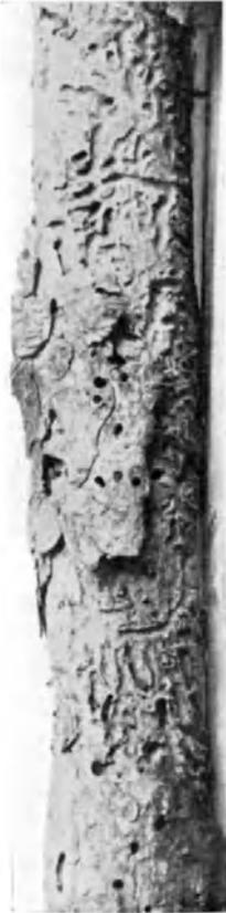
Abb. 89 c. Berindeter Kiefernast als Bilderrahmen benutzt und von Anobien zerstört. Nat. Gr.
