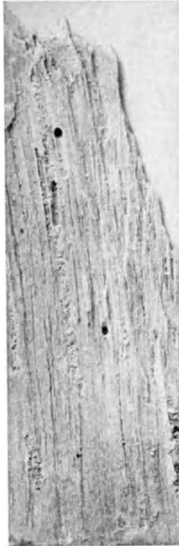
Abb 89 d. Kiefernholz auf dem Lagerplatz von Anobien befallen; man beachte, außer den dunklen freien Gängen, die mit Bohrmehl dicht gefüllt, das ganze Holz durchziehenden Gänge. Nat.Gr.
