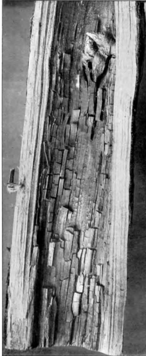
Abb. 57. Innere Holzdestruktion durch *Merulius silvester*. Hohle Kiefernklöbe, deren kohleartig zersetztes Kernholz bei der Bearbeitung größtenteils ausgefallen ist. Zwischen den Schwundspalten verlaufen Stränge des Pilzes. Verkl.
