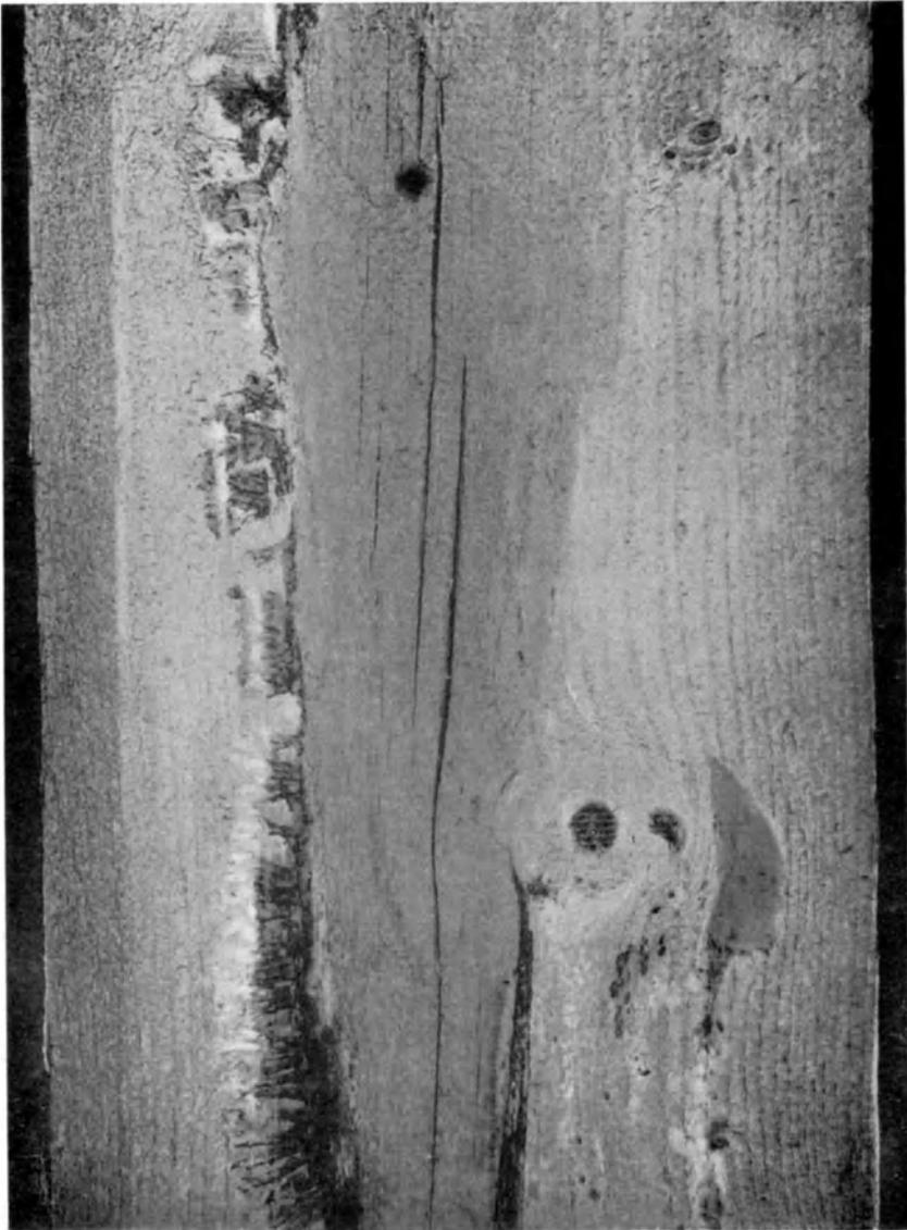
Abb. 81. Lenziteskranker Tannenbalken im Längsschnitt. Verkl. Orig.
