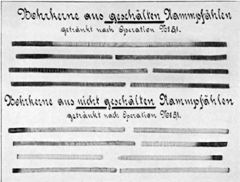
Abb. 199. Bohrkerne aus geschälten und ungeschälten imprägn. Rammspfählen, die das Eindringen des Teeröls von außen nach innen erkennen lassen. Bohrkerne sind den imprägn. Pfählen entnommene stabförmige Holzproben; sie sind in der Linie eines Durchmessers aus dem Pfahl herausgebohrt.
