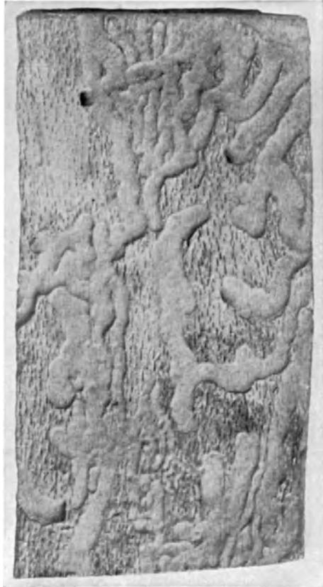
Abb. 108. Fraß von *Callidium variabile* an trockenem Buchenholz. Die Rinde ist abgehoben. Nat. Gr.
