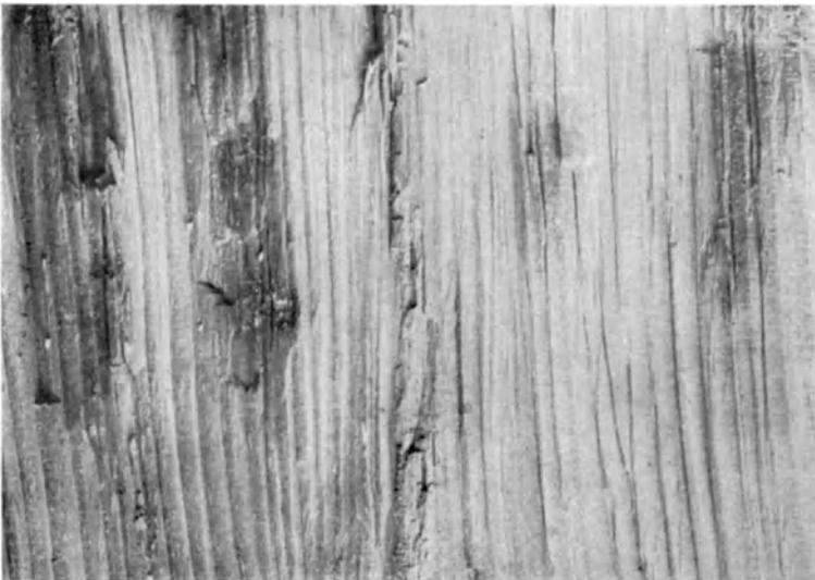
Abb. 80. Schwundlinsen auf radialen Spaltflächen von mit *Lenzites abietina* befallenem Balkenholz. Zeigt die ersten Infektionsherde, die von einzelnen Keimen ausgegangen sind.
