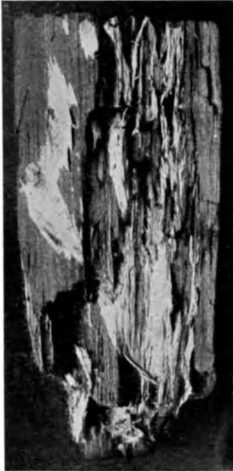
Abb. 55. Holzdestruktion durch *Merulius minor*. Natürliches Spalt- und Bruchbild eines von *M. minor* befallenen Lagerbalkens im Innern von seidenpapierartigen Myzellappen durchsetzt. (Aus Mykolog. Unt. u. Ber. H. I.)
