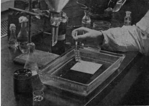
Ein Tropfen von Zaponlack ist auf Wasser getropft worden und hat sich zu einer sehr feinen Haut verteilt. Gerade soll der Objektträger unter die Zaponhaut geschoben werden, so daß beim Herausheben der Trägerplatte alle 8 Plättchen, die in der Mitte eine feine Öffnung tragen, mit dem Häutchen überzogen sind.
