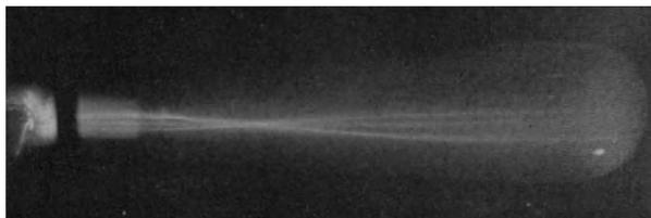
1930/31 Fokussierung und Überkreuzung von Elektronenstrahlen bei einer magnetischen Linse.
