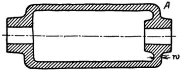
Abb. 124. Falsch. (Gefahr der Kernverlagerung!)
