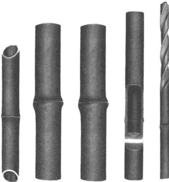
Abb. 46. Stumpfgeschweißte Rohre und Rundeisen.
