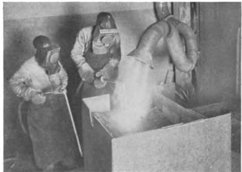
Abb. 204. Elektrische Warmschweißung eines Maschinenständers.
