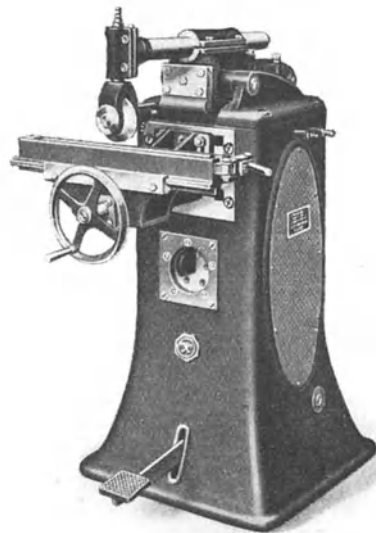
Abb. 74. Längsnahtmaschine mit rechtwinkliger Elektrodenstellung.
