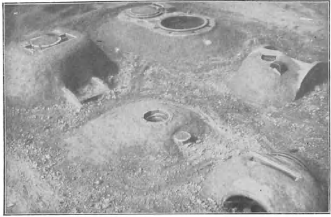
Abb. 206. Zur Warmschweißung vorbereitete Gußstücke.
