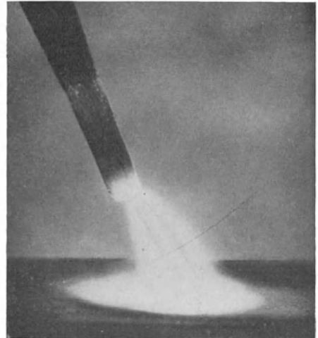
Abb. 93. Die richtungsweisende Kraft der Kohlelektrode.
