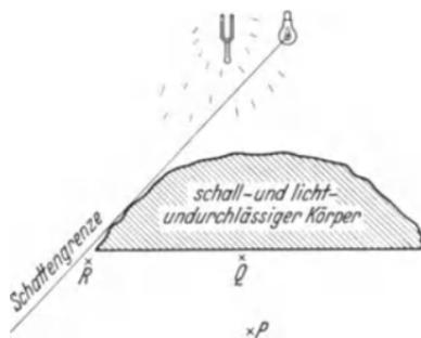
Abb. 18. Schall und Licht. Man hört in  $P$  die Stimmgabel, sieht aber nicht die Lampe; dies scheint der Wellentheorie des Lichtes zu widersprechen, rührt aber nur daher, daß die Länge der Schallwellen ungeheuer groß ist gegenüber der Länge der Lichtwellen. In  $Q$  hört man auch die Stimmgabel nicht, in  $R$  (innerhalb der Schattengrenze) sieht man bei geeigneter Anordnung auch (gebeugtes) Licht.
