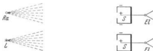
Abb. 46. Radiumstrahlen und Lichtquanten. Die einzelnen, vom Radiumpräparat *Ra* ausgesandten Teilchen rufen in der Ionisierungskammer *S* (Geigerscher Spitzenzähler) einzelne Stromstöße hervor; dasselbe vermögen die einzelnen Lichtquanten, wenn die Schwingungszahl hoch genug ist (z. B. bei Röntgenstrahlung). *El* Elektrometer.
