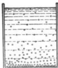
Abb. 11. Suspension in einer Flüssigkeit. Die Teilchen einer Suspension, die klein genug und nur wenig spezifisch schwerer als die Flüssigkeit sind, liegen nicht alle am Boden, sondern sind durch die ganze Flüssigkeit mit nach oben abnehmender Konzentration verteilt.
