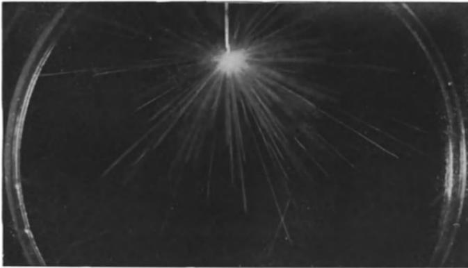
Abb. 37. Wege positiv geladener Radiumstrahlen, sichtbar gemacht nach Wilsons Nebelmethode.
