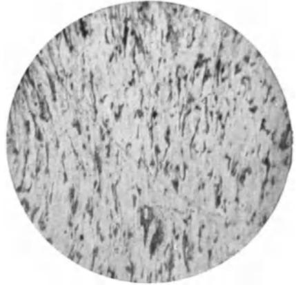
Fig. 163. Gedrückte Kristallkörper an der Stelle d in Fig. 161 a, mikroskopisch geätzt.  $V = 70$ .
