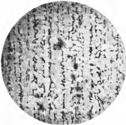
Fig. 153. Kaltgewalzter Flußstahl, im Längsschnitt, mikroskopisch geätzt. Walzstruktur.  $V = 70$ .
