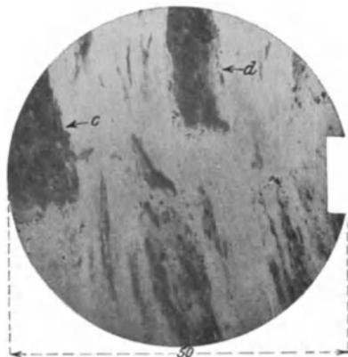
Fig. 1. Schweißeisen, Wagenachse im Querschnitt, makroskopisch geätzt (zeigt geflammtes Gefüge).
