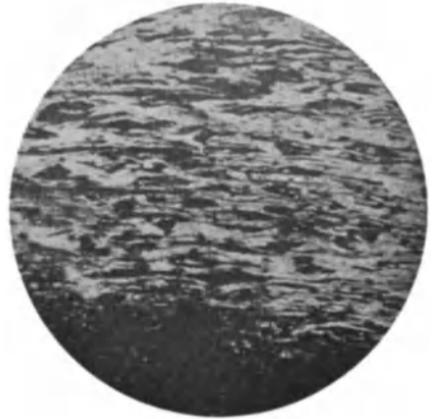
Fig. 170\*. Eisenbahnradreifen. Verzerrung der Kristalle an der Lauffläche des Reifens im Längsschnitt, makroskopisch geätzt.  $V = 94$ .
