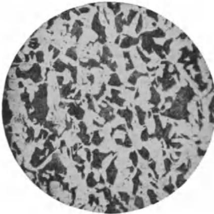
Fig. 66. Flußstahl mit 0,4% Kohlenstoff. Gefüge: Ferrit und Perlit etwa in gleicher Menge; mikroskopisch geätzt.  $V = 75$ .
