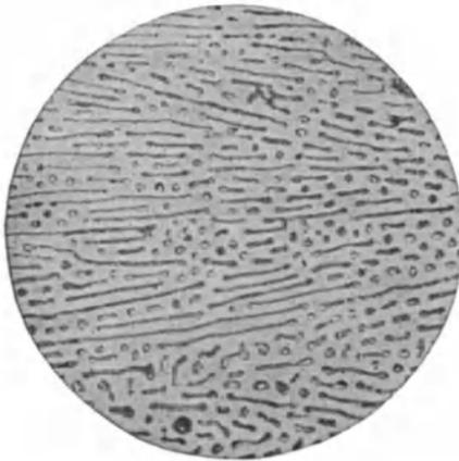
Fig. 109\*. Eisenlegierung mit  $4,2\%$  Kohlenstoff, rasch gekühlt; mikroskopisch geätzt. Gefüge: Ledeburit.
