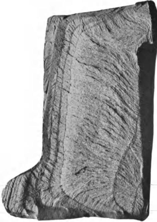
Fig. 17a\*. Trennungsbruchfläche eines Radreifens.
