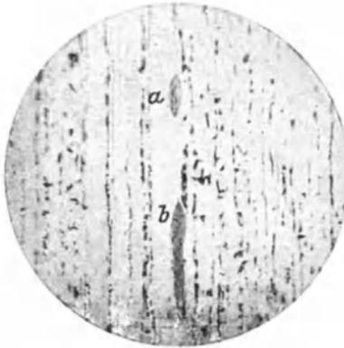
Fig. 186. Sulfideinschlüsse (a und b) in kohlenstoffarmem Flußstahl am Längsschliff, mikroskopisch geätzt.  $V = 70$ .
