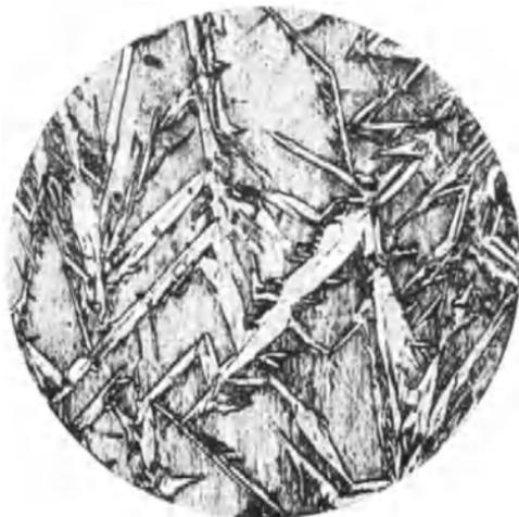
Fig. 78\*. Werkzeugstahl, mit 1,57% Kohlenstoff; bei  $1350^{\circ}$  C in Wasser von  $5^{\circ}$  C abgeschreckt, mikroskopisch geätzt. Gefüge: grobe Martensitnadeln in Austenit.  $V = 350$ .
