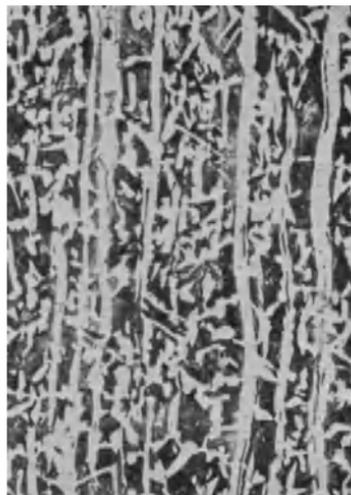
Fig. 152 b. Ferrit - Perlit - Zeilengefüge (sekundär) nach mikroskopischer Ätzung am Längsschnitt einer Flußstahlschiene.  $V = 75$ .
