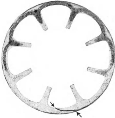
Fig. 16\*. Schwefelabdruck des Querschnittes eines Serve-Heizrohres aus Flußstahl mit Schwefelseigerung.
