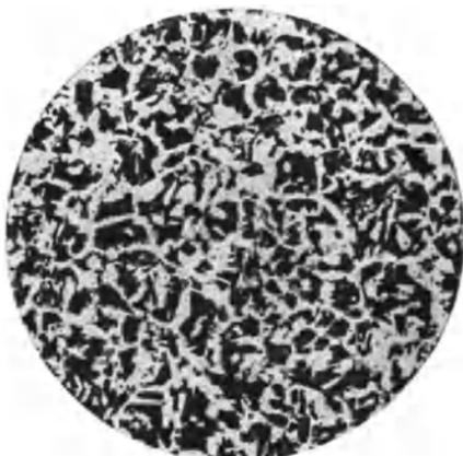
Fig. 139\*. Stahlguß (wie Fig. 138), richtig ausgeglüht, zeigt Kornstruktur; mikroskopisch geätzt.  $V = 46$ .
