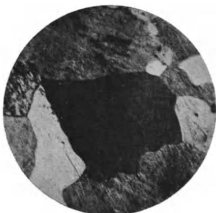
Fig. 146. Der gleiche Flußstahl wie Fig. 145, nach 36 stündigem Glühen, makroskopisch geätzt.  $V = 67$ .
