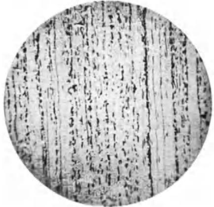
Fig. 154. Kaltgewalzter Flußstahl im Längsschnitt, mikroskopisch geätzt, Walzstruktur.  $V = 70$ .
