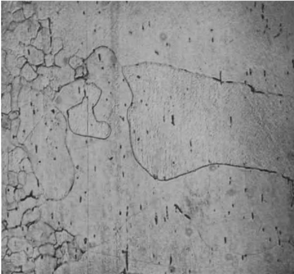
Fig. 173b\*. Kesselblech im Querschnitt nach der Rekristallisation zeigt örtlich sehr große Ferritkristalle.
