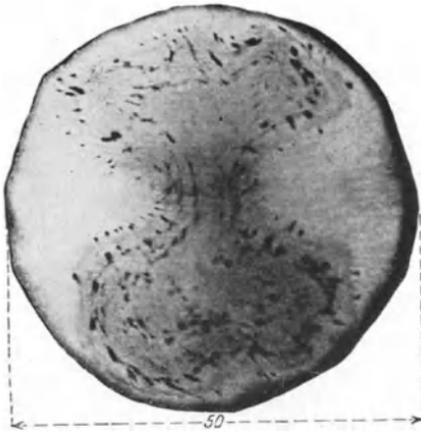
Fig. 35a. Flußstahlrundstab mit 8-förmiger Seigerung im Querschnitt, makroskopisch geätzt.
