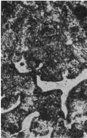
Fig. 115a. Handelsgrauguß, mikroskopisch geätzt, mit hohem Phosphorgehalt (1,25%), kenntlich an den vielen und großen hellen Inseln von Phosphideutektikum.
