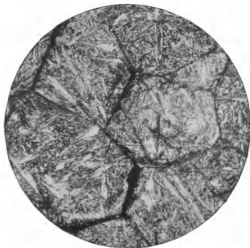
Fig. 88\*. Werkzeugstahl mit 1,54% Kohlenstoff, bei 1280° C in Wasser abgeschreckt, mikroskopisch geätzt, zeigt dunkle Härterisse und grobe Martensitnadeln.  $V = 200$ .
