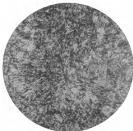
Fig. 89 a. Flußstahl mit 0,9% Kohlenstoff, mikroskopisch geätzt. Gefüge: Martensit.  $V = 450$ .
