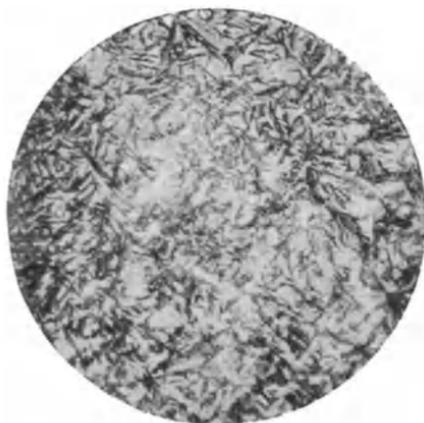
Fig. 82. Flußstahl mit 1,5% Kohlenstoff, bei 900° C abgeschreckt; mikroskopisch geätzt. Gefüge: Zementit und Martensit.
