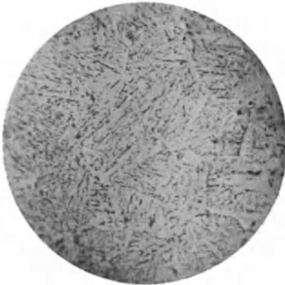
Fig. 87. Nach dem Erhitzen in Luft abgekühlter Flußstahl; mikroskopisch geätzt.  $V = 52$ .
