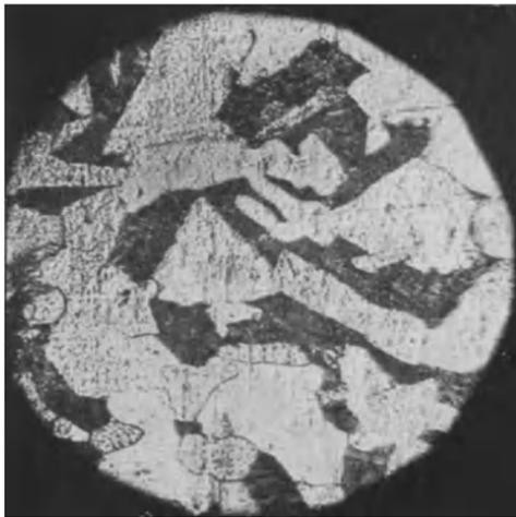
Fig. 74\*. Klingefüge des Teiles F (bei d) der Fig. 42 (Ferrit und Perlit), mikroskopisch geätzt. Der Kohlenstoffgehalt beträgt etwa  $0,25\%$ .  $V = 350$ .
