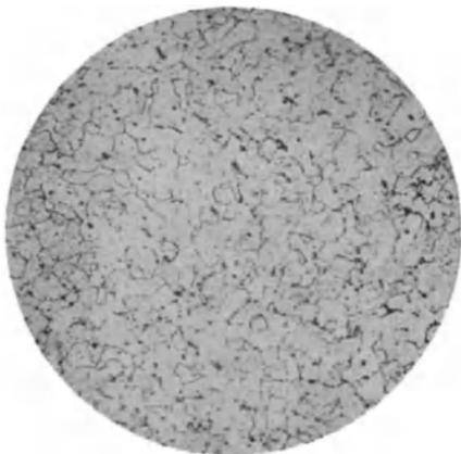
Fig. 135. Zellen- oder Netzstruktur in weichem Flußstahl, mikroskopisch geätzt. V = 75.
