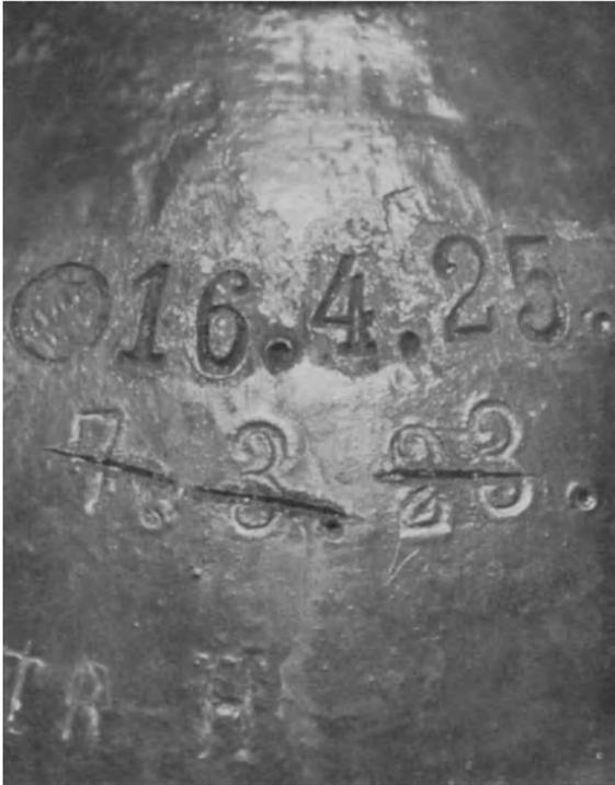
Fig. 160\*. Die eingeschlagenen Ziffern und Auslöschungen durch Meißelhiebe wirken als Kerben.
