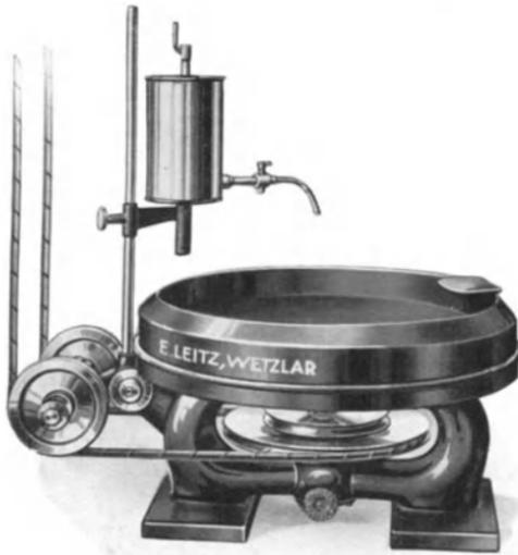
Fig. 49. Wagrechte Schleif- und Poliermaschine. Nach M. v. Schwarz.
