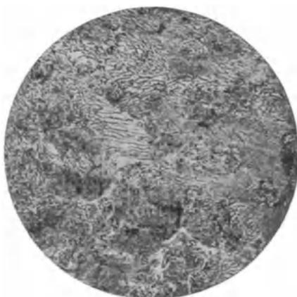
Fig. 89 b. Derselbe Stahl wie bei Fig. 89 a. Nach dem Ausglühen mikroskopisch geätzt. Gefüge: Lamellarer Perlit.  $V = 450$ .
