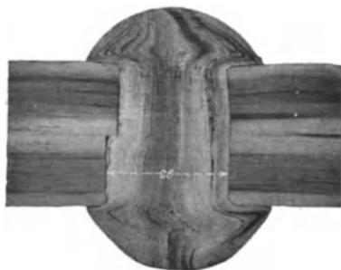
Fig. 29. Nietung, Flußstahlblech und Schweißeisenniete im Längsschnitt, makroskopisch geätzt.
