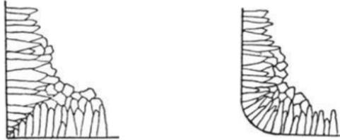
Fig. 136\*. Das Wachstum der Kristalle in Gußblöcken. (Nach C. H. Desch.)
