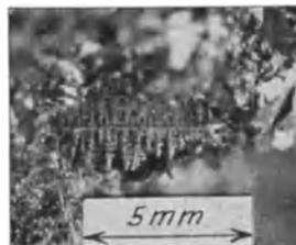
Fig. 133\*. Hohlstelle (Saugstelle) in Gußeisen mit bäumchenförmigem Kristall.
