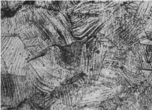
Fig. 184. Gleitlinien auf dem Manganhartstahl (Fig. 77) nach der Kaltverformung, mikroskopisch geätzt.  $V = 150$ .
