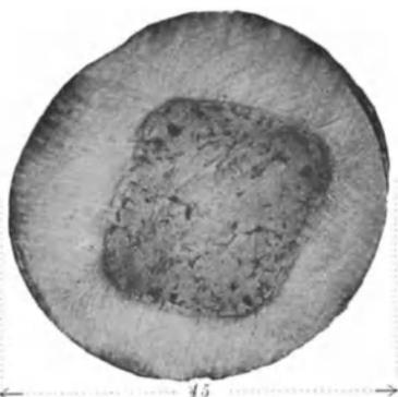
Fig. 22. Flußstahlrundstab mit starker Seigerung im Querschnitt, makroskopisch geätzt.
