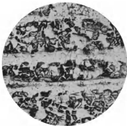
Fig. 151. Zeilenstruktur in dem Stege eines gewalzten Flußstahlträgers im Längsschnitt, mikroskopisch geätzt.  $V = 75$ .
