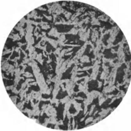
Fig. 169\*. Eisenbahnradreifen, normales Gefüge im Längsschnitt, makroskopisch geätzt.  $V = 94$ .
