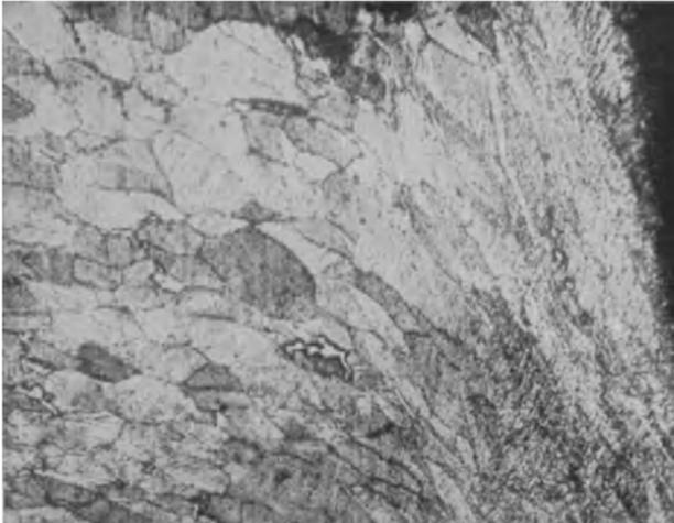
Fig. 171. Stark gereckte Ferritkristalle am Grunde des Gewindes einer
