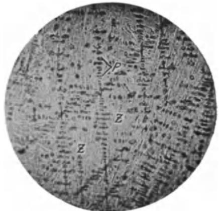
Fig. 121. Hartguß, weißer Rand; mikroskopisch geätzt. Gefüge: Perlit und Zementit. V = 52.
