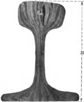
Fig. 5. Querschnitt einer Eisenbahnschiene aus Schweiß Eisen, makroskopisch geätzt mit Riß bei e.
