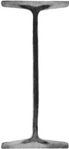
Fig. 13a. I-Flußstahl mit starker Seigerung, im Querschnitt, makroskopisch geätzt (stark verkleinert).
