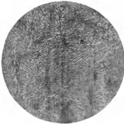
Fig. 68. Flußstahl mit (nahezu) 0,9% Kohlenstoff. Gefüge: Perlit; mikroskopisch geätzt.  $V=450$ .
