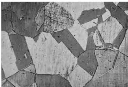
Fig. 77\*. Manganhartstahl mit etwa 12% Mangangehalt zeigt „polyedrisches Gefüge“ von Austenitkristallkörnern. Mikroskopische Ätzung.  $V = 150$ .
