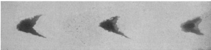
Fig. 179. Polierter Längsschnitt durch den überzogenen Draht nach Fig. 178 zeigt die gewaltige Ausdehnung der inneren, von außen nicht sichtbaren Hohlräume.  $V = \text{etwa } 2$ .
