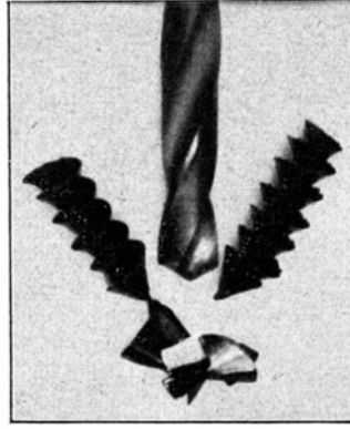
Späne von Ms 63. Bohrer mit normaler Spirale.
