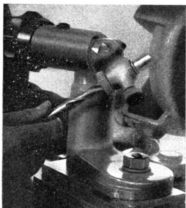
Abb. 60. Schleifmaschine für kleine Bohrer bis 13 mm (R. Stock & Co.).
