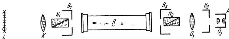
Abb. 8. Anordnung der optischen Teile eines Polarimeters.
