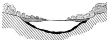
Abb. 22. Entstehung eines Wasserkissens unter einer Moordecke (nach E. K a y s e r).
