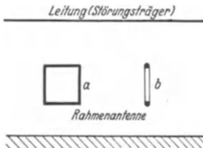
Abb. 33. Anpeilen des Störfeldes einer waagerechten Leitung mit Rahmenantenne.
