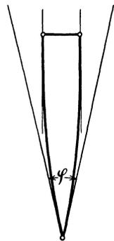
Abb. 212. Verdrehwinkel eines Kurbelkropfes.
