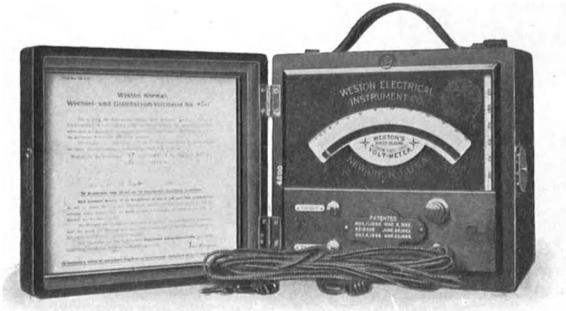
Fig. 255. Elektrodynamisches Voltmeter von Weston für direkte Ablesung.
