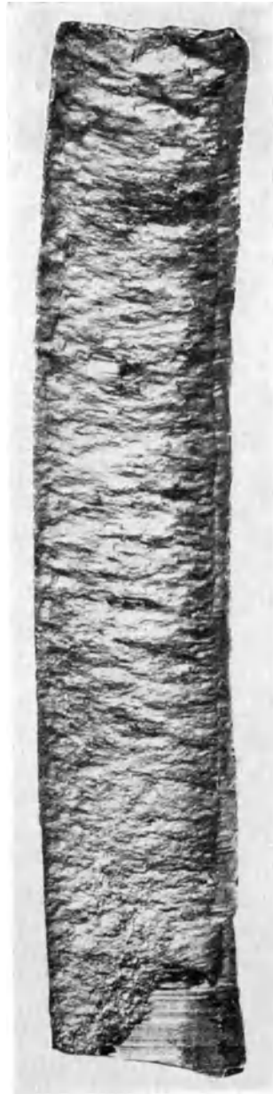
Abb. 161. Schnittfläche einer Messinggußplatte (Ms. 63). Verschiedenartiges Aussehen infolge von zweierlei Kristalltextur. V. 1.
