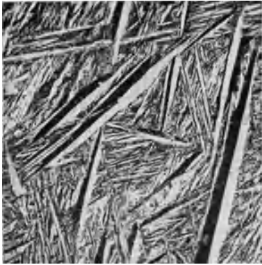
Abb. 37. 85,75 % Cu, 14,25 % Al, von 870^{\circ} abgeschreckt: \beta grobnadelig. V = 30 .
