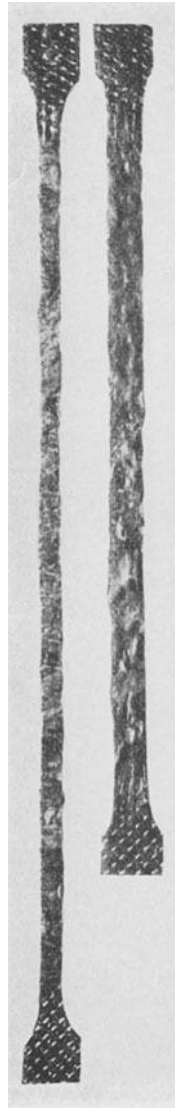
Abb. 168. Die gleichen Stäbe wie Abb. 167 nach dem Zerreißfen (auf \frac{1}{2} verkleinert). Oberer Stab: Bruchfestigkeit: 27,0 kg mm 2 ; Dehnung 49% Unterer Stab: Bruchfestigkeit: 22,9 kg mm 2 ; Dehnung 37%
