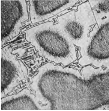
Abb. 27. 90,7% Cu, 9,3% Sn. Gußgefüge: Zonenkristalle mit dunklem Kern und heller Umrandung; \alpha . Scharfgezackte Inseln: Eutektoid \alpha + \delta . — Ätzung \text{FeCl}_3 + \text{HCl} . V = 250 .
