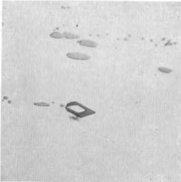
Abb. 183. Mit Zinn verunreinigtes Kupferblech. Dunkler rhombischer Kristall in der Mitte: Zinnsäure \text{SnO}_2 . Länglichrunde Einschlüsse: Kupferoxydul \text{Cu}_2\text{O} , durch Walzen gestreckt. — Ungeätzt. V = 900 .
