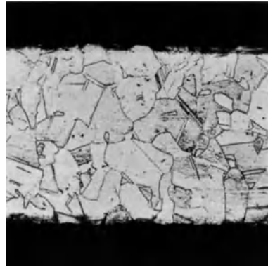
Abb. 94. Wie Abb. 93. \beta durch Anlassen bei 550° gelöst. V = 50 .
