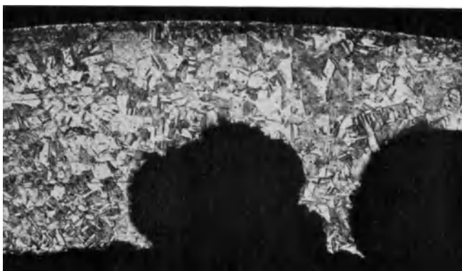
Abb. 73. Luftblasen-Korrosion von \alpha -Messing (Kondensatorrohr) 70,7% Cu. Keine Entzinkung im Gefüge. V = 40 .
