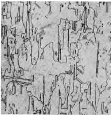
Abb. 17. 62,2% Cu, nach scharfer Abschreckung von 890^\circ (s. Abb. 15) gegläht bei 500^\circ : reines \alpha = Gefüge. V = 50 .
