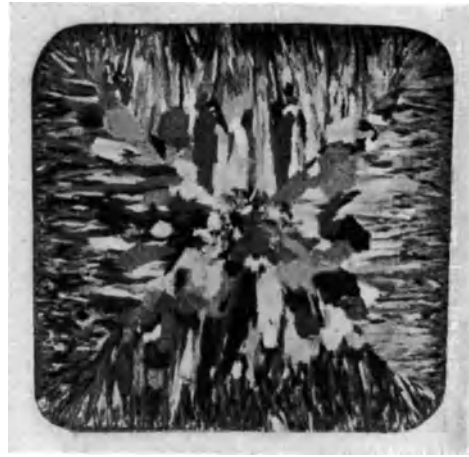
Abb. 163. Aluminiumbronzeblock, Querschnitt, stehend in Kokille vergossen. Starke Einstrahlung. V = 0,5 .
