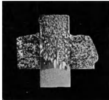
Abb. 192. Rundstange 13 mm \varnothing aus Ms 58 mit aufgelöteten Gußmessingring. Unterer Teil der Stange: feinkörnig, hart. Oberer Teil: grobkörnig, rekristallisiert. Schmale Zwischenzone: große \beta -Kristalle. V = 1 .
