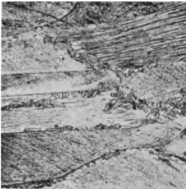
Abb. 85. Kalt gewalztes Blech 2,4 mm dick Ms 72, kurze Zeit bei schwacher Hitze gegläht, Rekristallisationsbeginn an den Korngrenzen. V = 200 .
