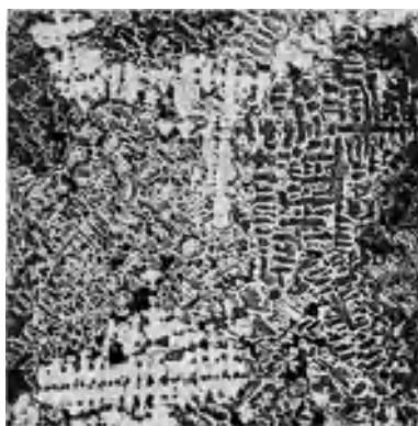
Abb. 23. 94,3% Cu, 5,7% Sn, Gußgefüge: \alpha -Zonenkristalle mit etwas ( \alpha + \delta )-Eutektoid. Ätzung \text{FeCl}_3 + \text{HCl} . V = 50 .
