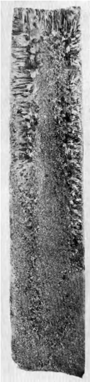
Abb. 162. Dieselbe Fläche wie Abb. 161 nach Ätzung: links feinkörnig, rechts nadelig erstarrt. V = 1 .
