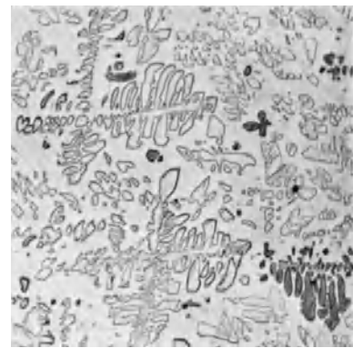
Abb. 40. 85,75 % Cu, 14,25 % Al, normal abgekühlt. Helle Grundmasse: \beta . Verzweigte Kristalle teils hell, teils dunkel: \delta . — Ätzung \text{FeCl}_3 + \text{HCl} . V = 100 .
