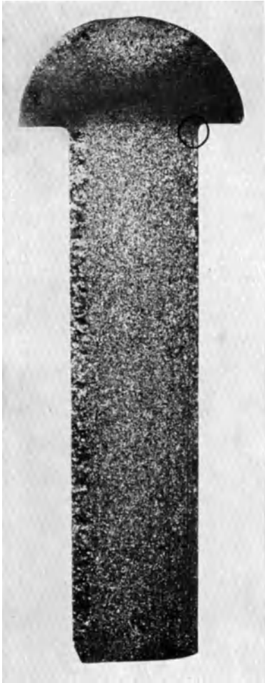
Abb. 179. Kalt geschlagener Messingniet aus Ms 67. Fließstruktur im Verformungsbereich des Kopfes. V = 2 .
