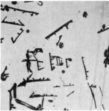
Abb. 185. Wie Abb. 182, Zinkoxyd-Einschlüsse in Messing, stärker vergrößert. — Ungeätzt. V = 400 .
