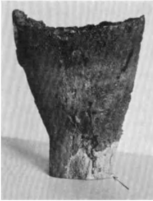
Abb. 154. Rotguß Rg 9 mit umgekehrter Seigerung. Durch den Pfeil bezeichnete Stelle: herausgequollener zinnreicher Schmelzrest. V = 0,6 .
