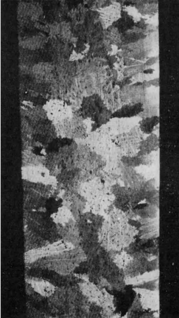
Abb. 172. Teilquerschnitt durch einen 80 kg schweren Sandgußblock Ms 63. Randzonen dicht, Mitte stark porös. Keine Stengelkristalle. V = 1 .
