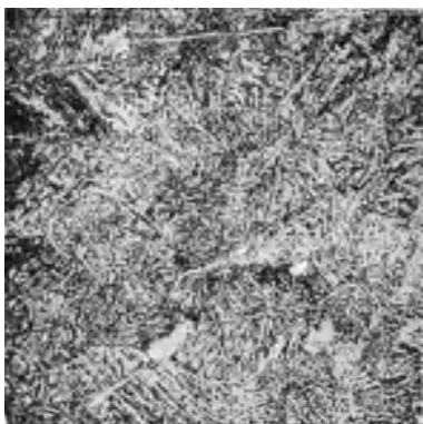
Abb. 195. Stelle A von Abb. 194. Gußstruktur der Schweißung. V = 45 .
