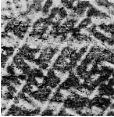
Abb. 2. 85,2% Cu, \frac{1}{2} St. bei 650° geglüht. Verwaschene Zonenkristalle. V = 100.
