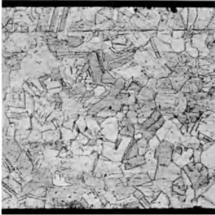
Abb. 89. Blech 0,5 mm dick, 63,5 % Cu, von 625° an der Luft abgekühlt: \alpha -Gefüge. V = 100 .
