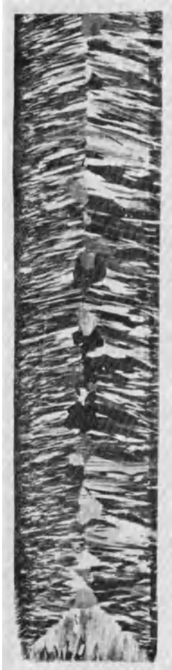
Abb. 160. Gehobelter Längsschnitt durch eine Messinggußplatte (Ms 63), stehend in Eisenkokille vergossen. Hervortreten des Erstarrungsgefüges ohne Ätzung. V = 0,4 .
