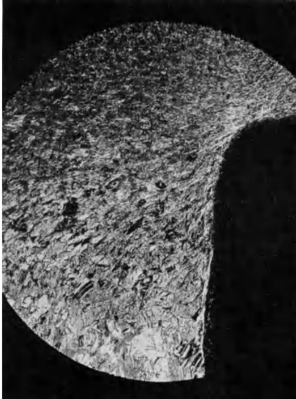
Abb. 180. Die auf Abb. 179 eingekreiste Stelle stärker vergrößert. Übergang vom Kopf zum Schaft des Nietes. V = 30 .
