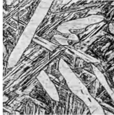
Abb. 38. 89,9 % Cu, 10,1 % Al, von 750^{\circ} abgeschreckt. Weiße Inseln: \alpha ; Grundmasse: \beta nadelig. V = 200 .
