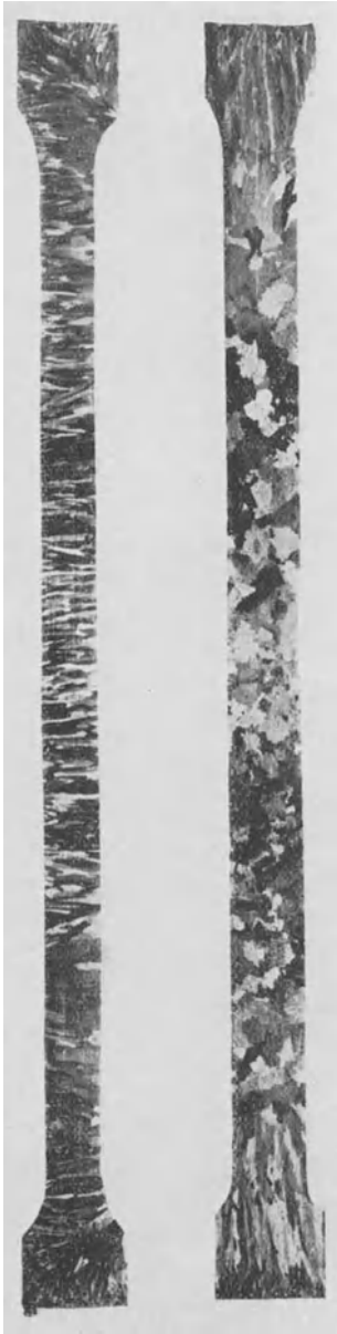
Abb. 167. Zerrießstäbe aus verschiedenen Erstarrungszonen derselben Gußplatte, vgl. Abb. 164, V = L.
