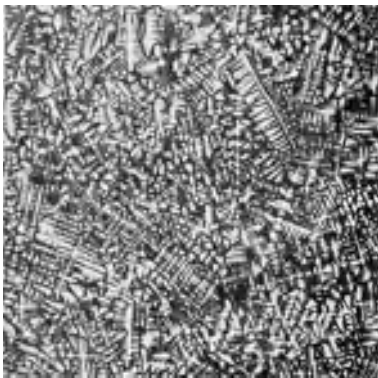
Abb. 64. Gußgefüge von Kupfer mit 0,87% Arsen. Arsenarme Dendriten in arsenreicher dunkler Grundmasse. — Ätzung \text{FeCl}_3 + \text{HCl} . V = 5 .
