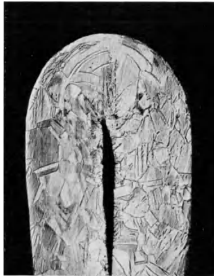
Abb. 76. Das gleiche Blech wie auf Abb. 74 u. 75, nach Verflüchtigung des Quecksilbers wieder biegefähig. V = 14 .
