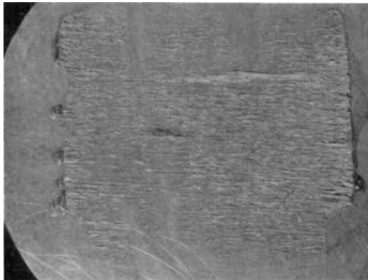
Abb. 8. Bild einer schlechten Fuge zwischen Stahl und Holz. Grund: Un- genügende Entfettung der Stahlscheibe. Die Fuge wurde durch Abdrücken gewaltsam zerstört. Verleimung \tau_{z, \pm x} bzw. \tau_{z, \pm y}
