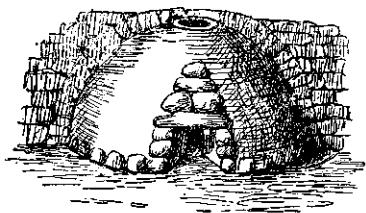
Примитивная железоплавильная печь По Веку
