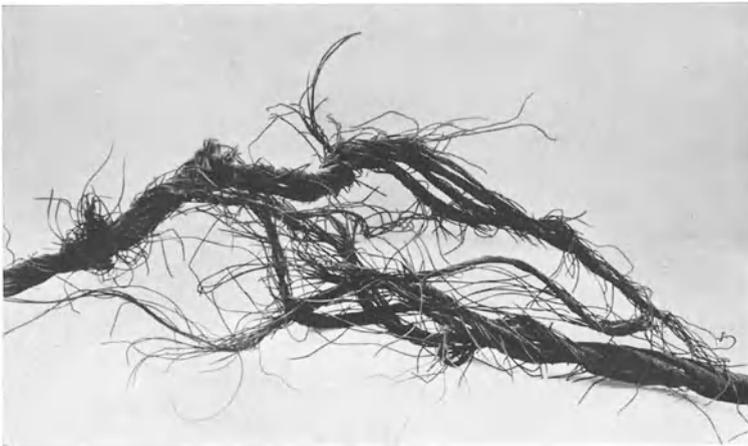
Abb. 71. Unmittelbar über dem Einband gerissenes Förderseil.
