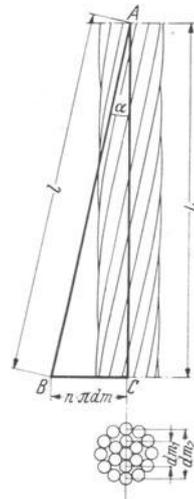
Abb. 32. Schematische Darstellung der Flechtverhältnisse bei normalen Litzen.
