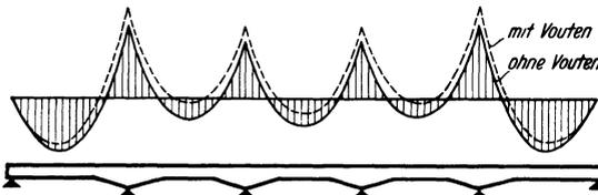
Abb. 139. M-Verlauf beim Durchlaufträger mit und ohne Vouten.
