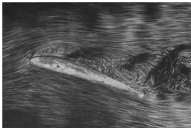
Abb. 167. Bei zu großem Anstellwinkel reißt die Strömung vom Flügel ab.
