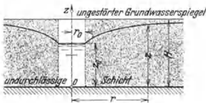
Abb. 134. Grundwasserabsenkung mittels eines „vollkommenen“ Brunnens.
