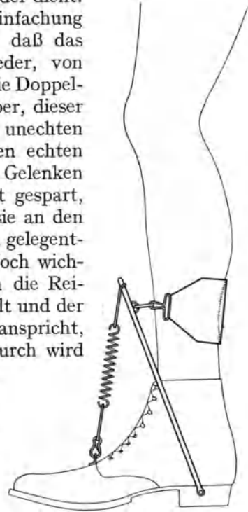
Fig. 51. Spannwerk. Unser Spitzfußapparat Modell PSp, schematisch.
