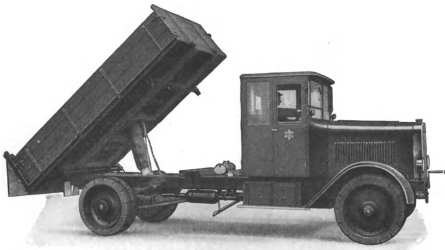
Abb. 25. Lastkraftwagen Type 6 C 1 der Henschel & Sohn A.-G. mit Dreiseitenkippvorrichtung.
