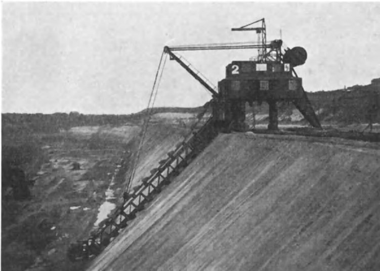
Abb. 2. Portalbagger, Type E II der L.M.G. mit elektrischem Antrieb.
