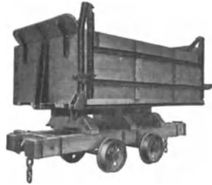
Abb. 39. Einseitig kippender normaler Holzkastengerät von 4 m 3 Inhalt der Firma Leipziger & Co.
