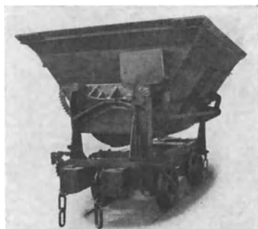
Abb. 38. Einseitig kippender Großmuldenkippselbstentlader von 6 m 3 Inhalt der Firma Leipziger & Co.
