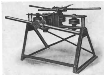
Abb. 31. Schienenbiegemaschine Robel 6 für Handbetrieb.
