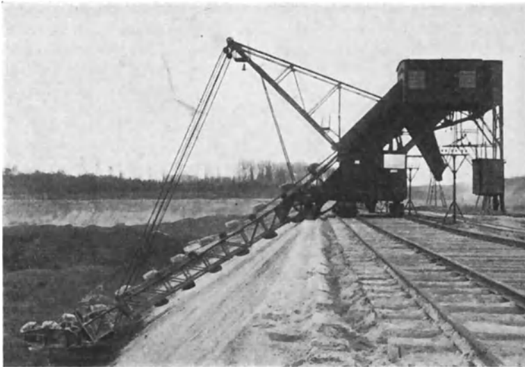
Abb. 4. Seitenschütter, Type E III der L.M.G. mit elektrischem Antrieb.
