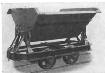
Abb. 37. Excelsior-Muldenkipper für Lokomotivbetrieb der Firma Leipziger & Co.
