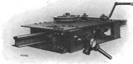
Abb. 32. Schienenbiegemaschine Robel 5 für Hand- und Kraftbetrieb.
