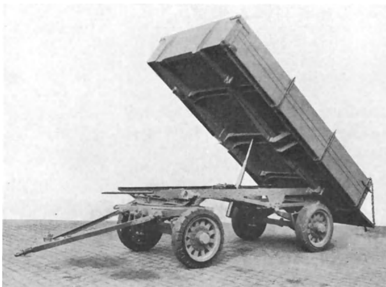
Abb. 26. Lastkraftwagen-Anhänger der Firma J. Rockinger in München mit Dreiseitenkipprück- vorrichtung.
