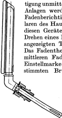
Abb. 2138. Schiefwinkliges Thermometer mit offenem Tauchrohr und Flachgehäuse (Schäffer & Budenberg).
