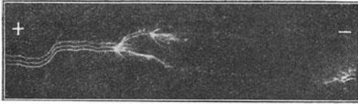
Abb. 348. Vorentladungen ohne vollständigen Übergang.
