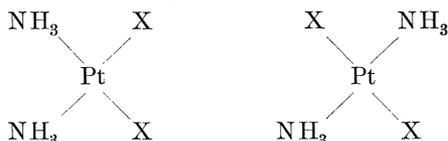
Wir kennen gegenwärtig eine ganze Reihe synthetisch dargestellter Platinverbindungen, welche in diesem Sinne stereoisomer sind und in denen die X-Radikale beträchtlich variieren. Einer der interessantesten Fälle ist jener, in welchem X eine Aminoverbindung vorstellt; denn obgleich die vier Radikale einen ähnlichen chemischen Charakter besitzen, so genügt doch schon die Verschiedenheit zwischen dem  $\text{NH}_3$  und der Aminogruppe um die Isomerie zu erzeugen.
