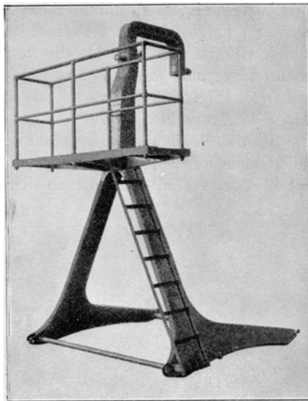
Fig. 283. Stahlgehänge der Wagen der neuen Kohlererbahn.
