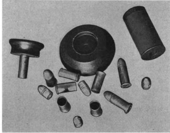
Abb. 84. Kugelsetzer aus Preßstoff für die Revolverpatrone Kal. 44 S. & W. Russian.
