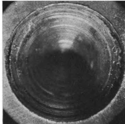
Abb. 33. Verschleißkrater in Bronze. Vergrößerung 12fach.
