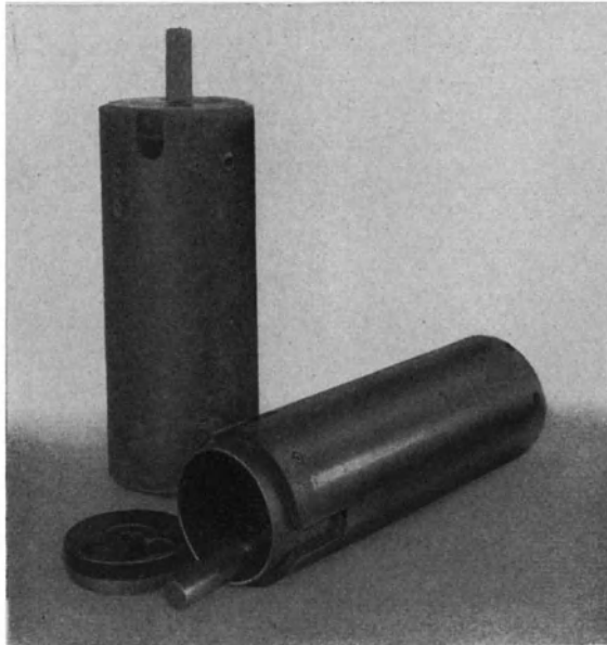
Abb. 81. Bohrlehre zum Bohren zylindrischer Stücke.
