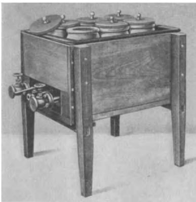
Abb. 125. Färbeherd zur Ausführung von Probe- und Musterfärbungen. (Eduard Esser & Co. G.m.b.H. Görlitz.)
