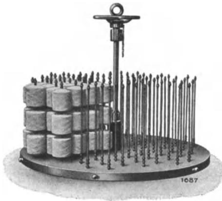
Abb. 91. Färbeplatte für zylindrische Kreuzspulen. (Zittauer Maschinenfabrik A. G. Zittau.)
