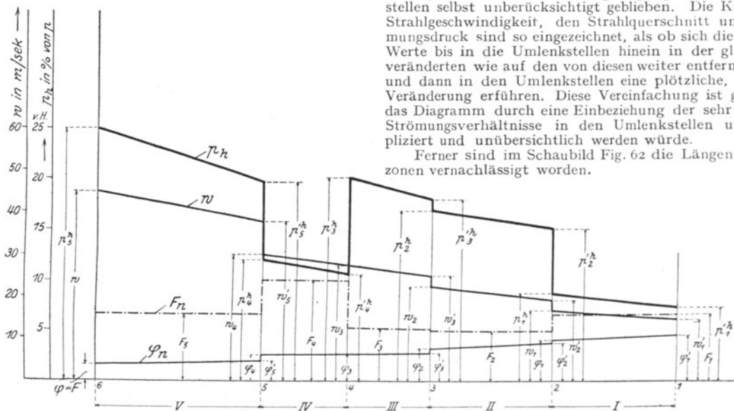
Fig. 62. Schaubild des Strömungsverlaufes in der Form (Fig. 53/54):
