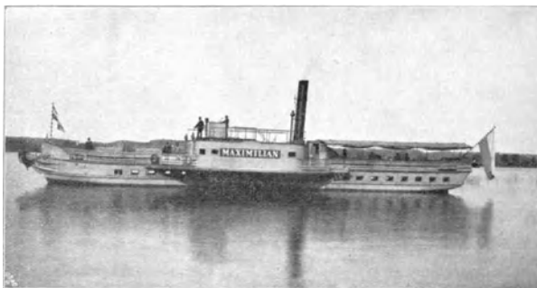
Länge 160' engl., Breite 15' engl.; oszillierende Zwillingmaschine mit Kondensator; Leistung 250 PS.
